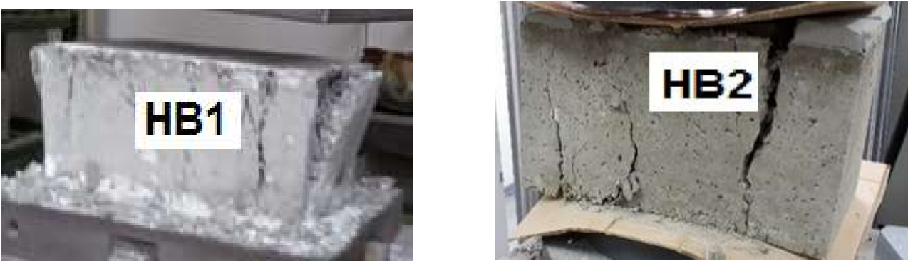
Fig.5 - Failure modes of concrete hollow blocks/ Moduri de cedare a blocurilor din beton cu goluri
