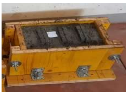
Fig.2 – Molded and demolded concrete hollow blocks/ Blocuri din beton cu goluri în cofraj și după decofrare
