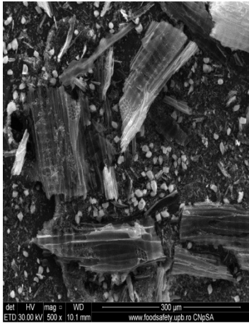
Fig.5. - SEM image of willow ash Imaginea SEM a cenușii de salcie.
