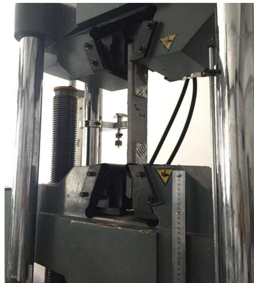
Fig. 4 - Specimen fixed in the testing machine. / *Epruvetă montată în mașina de testare.*
