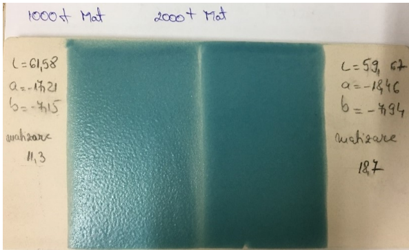
Fig. 7 - Glazes obtained by grinding raw mixtures for matte glazes at 1000 (left) and 2000 (right) rotations, showing a visible, higher roughness of the surface for 1000 rotations / Glazuri mate obținute prin măcinarea materiilor prime la 1000 (stânga) și 2000 rotații (dreapta). Rugozitatea suprafeței din stanga este vizibil mai mare.
