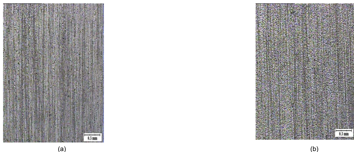
Fig. 8 - The aspect of steel strip surface after electroless deposition at 80°C for 45 minutes, Magnification: x 40 a) with Ni-P coating and b) with Ni-P-nanoAl 2 O 3 coating / Aspectul suprafeței benzii de oțel după depunerea electroless la 80°C timp de 45 de minute, mărire: x 40 a) cu acoperire Ni-P și b) cu acoperire Ni-P-nanoAl 2 O 3
