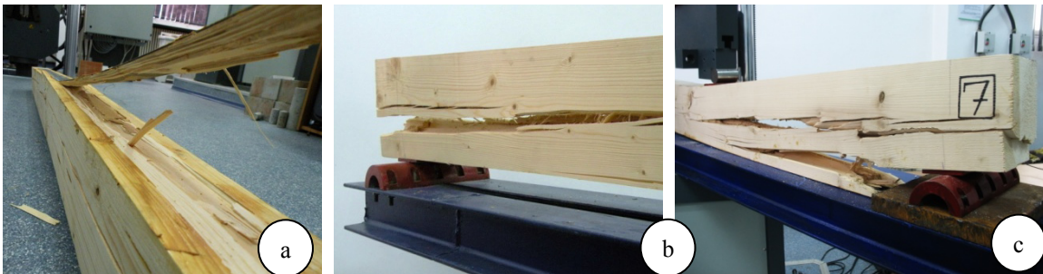
Fig. 5 – Moduri de cedare ale grinzilor din lemn consolidate conform: / Failure modes of timber beams strengthened according to: a) Soluției A / Solution A, b) Soluției B / Solution B, c) Soluției C / Solution C.
