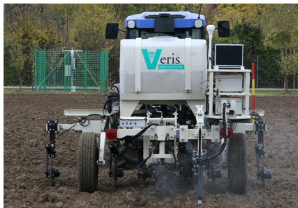
Fig. 1 - Complex combined equipment for scanning of the soil properties / Echipament combinat complex pentru scanarea proprietăților solului.
