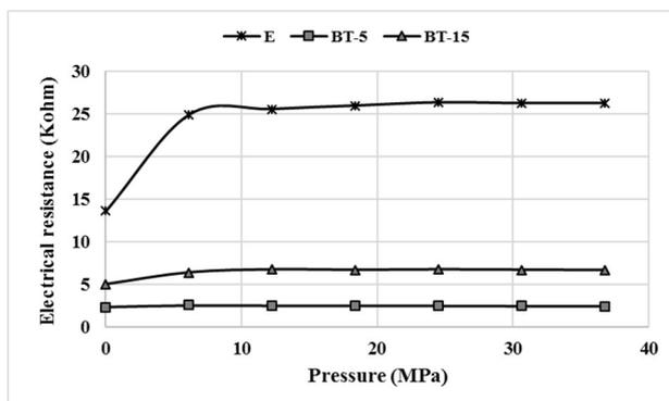
Fig. 7 – The electrical resistance (R<sub>g</sub>+R<sub>gb</sub>) values for E, BT5 and BT15 hardened for 90 days with different loading pressure / Rezistența electrică pentru masele E, BT5 și BT15 întărite 90 de zile la variația presiunii de încărcare.
