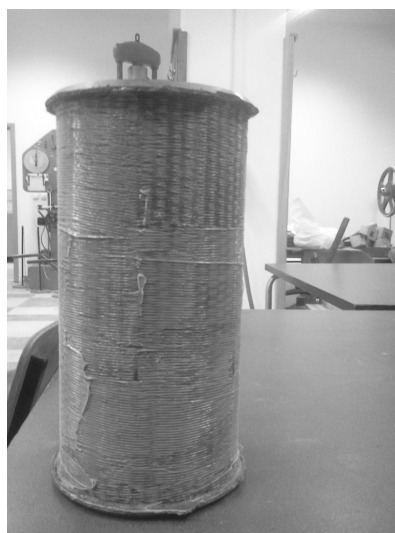
Fig. 4 - Aplicarea compozitului TFC pe suprafața laterală a cilindrilor / Application of the composite TFC on the side surface of the cylinder.
