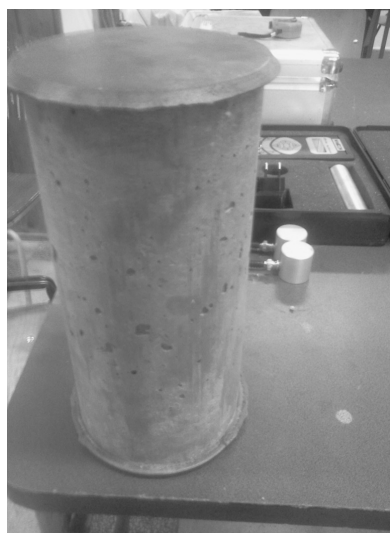
Fig. 4 - Aplicarea compozitului TFC pe suprafața laterală a cilindrilor / Application of the composite TFC on the side surface of the cylinder.
