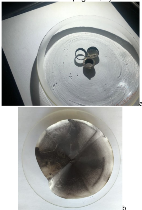
Fig. 5 - Steel case after cleaning operation (a); recovery of the active paste by filtering the acetic acid solution after the ultrasonic operation (b) / Carcasa din oțel după operația de curățare (a); recuperarea pastei active prin filtrarea soluției de acid acetic după operația de ultrasonare (b).
