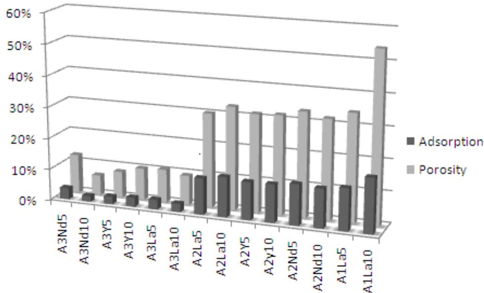
Fig. 2 – Variation of adsorption and porosity with composition for T=1500 °C / Variația adsorbției și a porozității la T=1500 °C.
