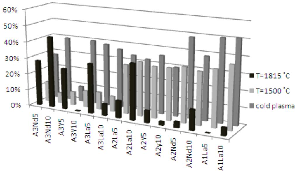
Fig. 6 - Variation of porosity with composition and sintering temperature / Variația porozității în funcție de compoziție și temperatura de sinterizare.
