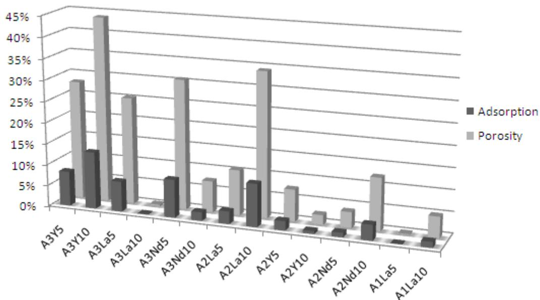
Figure 3 – Variation of adsorption and porosity with composition for T=1815 °C / Variația adsorbției și a porozității la T=1815 °C.
