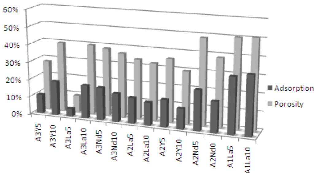
Fig. 4 - Variation of adsorption and porosity with composition for cold plasma-plasma sintering / *Variația adsorbției și a porozității în plasmă rece.*
