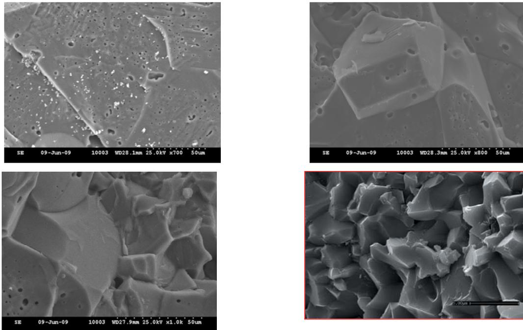
Fig. 12 - SEM's of different A3 samples (the picture from the bottom right corner is alumina taken from literature – for comparison purposes) with different additions (La, Nd, Y) sintered at 1815 °C / *Micrografiile unor probe A3 (figura din colțul dreapta jos este o micrografie a aluminei luată din literatură – pentru comparație) cu dopanți diferiți (La, Nd, Y) sinterizate la 1815 °C.*
