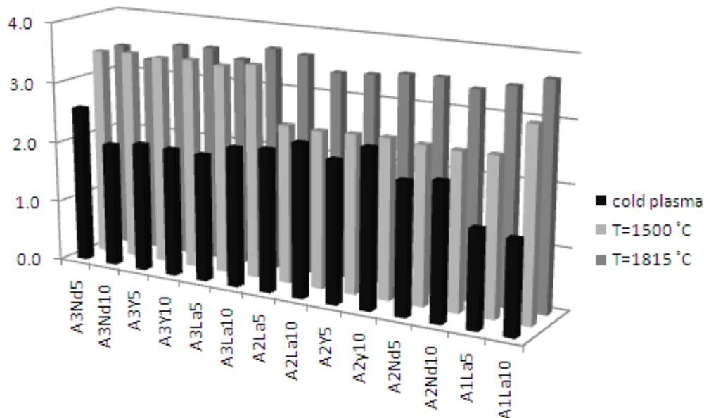
Fig. 7 - Variation of density with composition and temperature / Variația densității în funcție de compoziție și temperatura de sinterizare.
