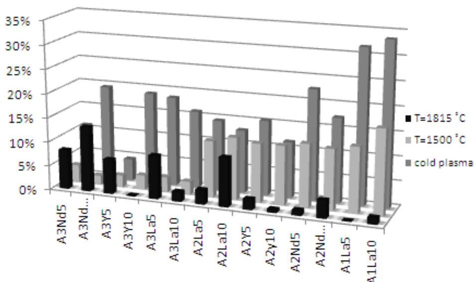
Figure 5 – Variation of adsorption with composition and sintering temperature / *Variația adsorbției în funcție de compoziție și temperatura de sinterizare.*
