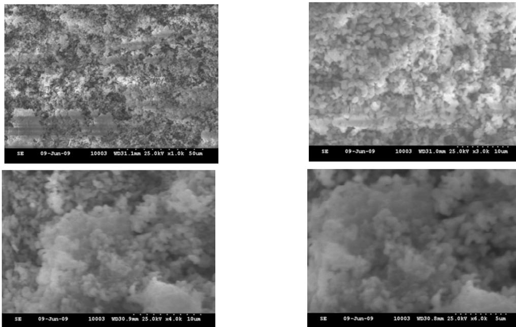
Figure 11 – SEM of A1La10 sintered in cold plasma / Micrografia probei A1La10 sinterizată în plasmă rece.
