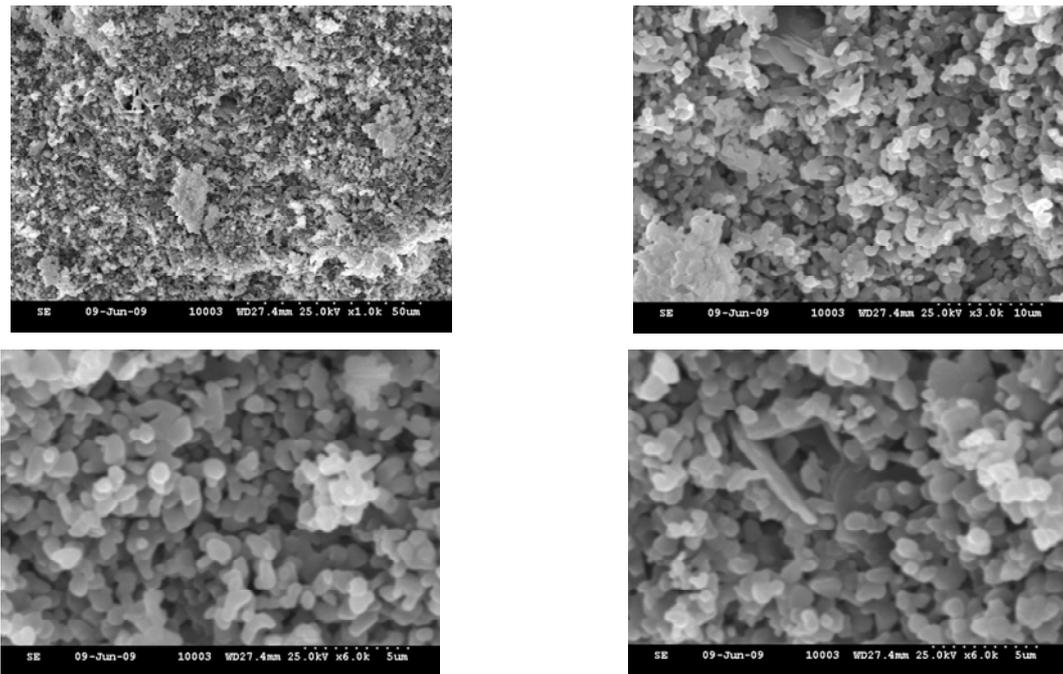
Fig. 9 - SEM of A1La10 sintered at 1500 °C / *Micrografia probei A1La10 sinterizată la 1500 °C*
