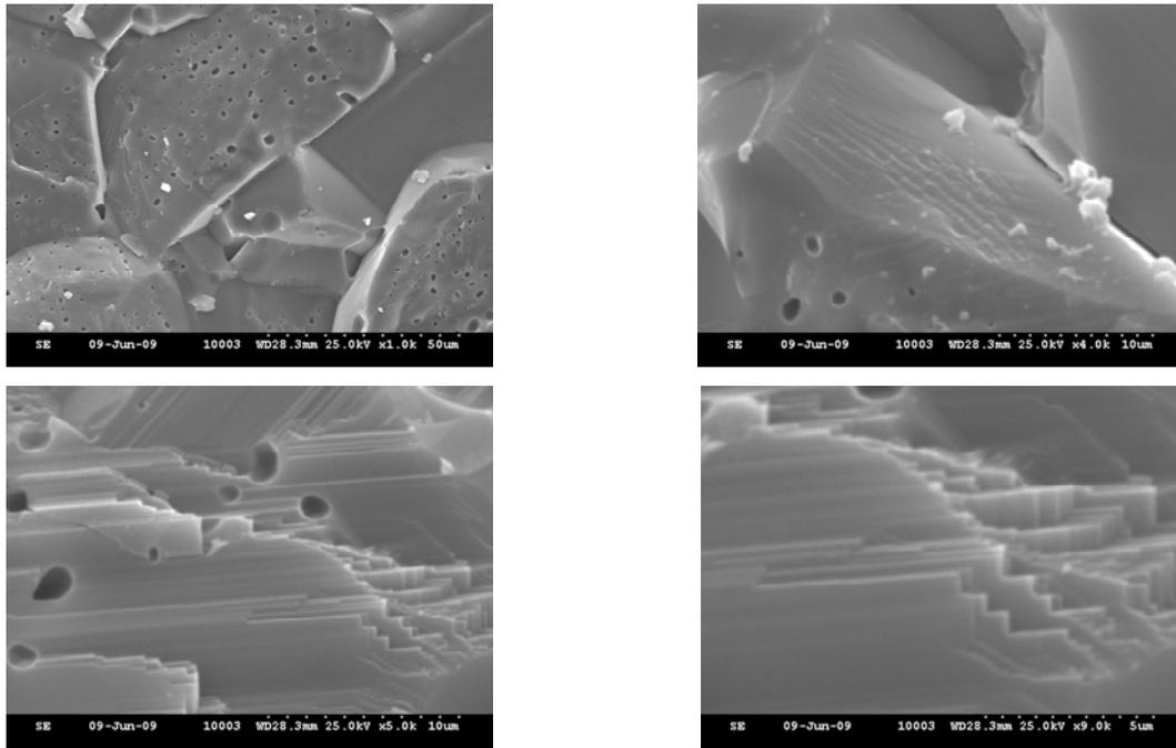
Fig. 10 - SEM of A1La10 sintered at 1815 °C / Micrografia probei A1La10 sinterizată la 1815 °C.
