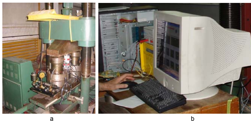
Fig. 2 - Instalația de încercare pentru curba caracteristică completă a betonului: a - detalii ale dispozitivului brevetat pentru curba caracteristică completă; b - modulul pentru achiziția datelor/ Experimental set-up for the complete stress-strain curve of concrete: a - details of the device for complete stress-strain curve; b - data acquisition module.
