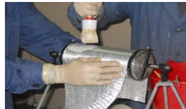
Fig. 1 - Pregătirea epruvetelor cilindrice confinate: a - dimensiunile principale ale epruvetei din beton și lățimea benzii de țesătură; b - aplicarea rășinii epoxidice pe epruveta fără cămășuială; c - impregnarea țesăturii pentru formarea membranelor compozite cu fibrele din sticla dispuse după circumferință / Preparation of the confined cylindrical specimens: a - main dimensions of concrete specimen and width of fabric; b - application of epoxy resin on unconfined concrete sample before the confining; c - confining procedure of concrete samples using glass fabrics with fibres oriented circumferentially.
