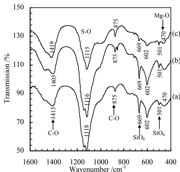
Fig. 3 - FTIR spectra of Mortar C0 after exposure to different sulfate solutions for 1 year. (a) at 5°C; (b) at 20°C; (c) at cycling temperature / Spectrele FTIR ale mortarului C0 după expunerea timp de un an în soluție de sulfat: a) la 5°C; b) la 20°C, c) la temperaturi alternante.
