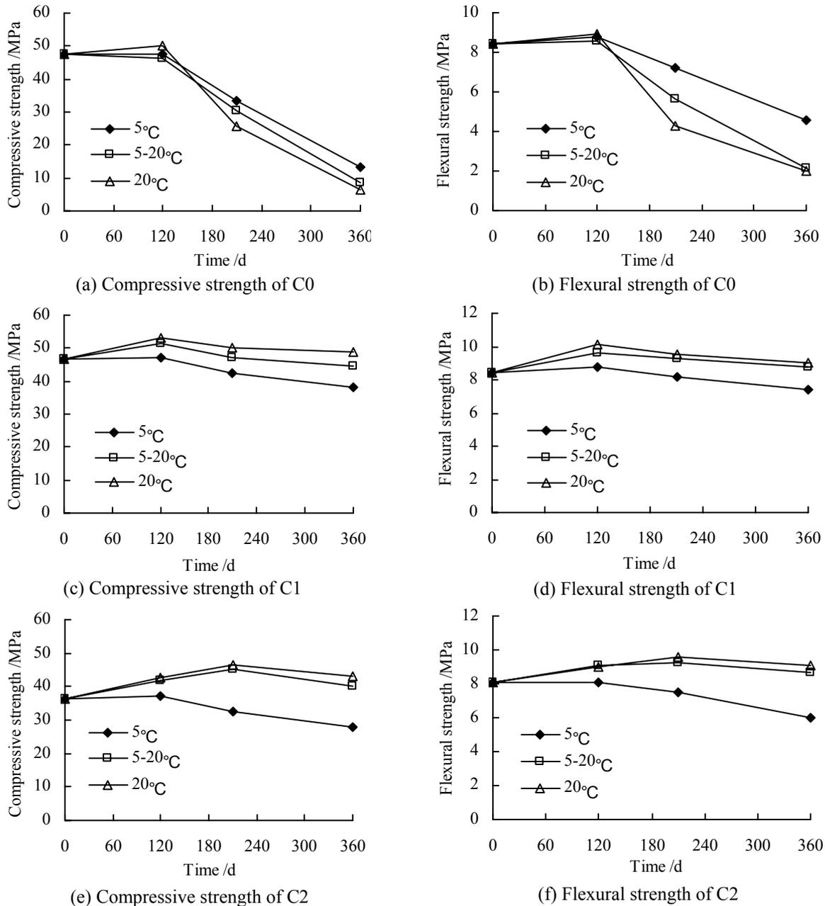
Fig. 1 - Strength development of the mortars with immersion times/Evoluția rezistenței mecanice a mortarelor imersate în soluție 2% de sulfat de magneziu.
