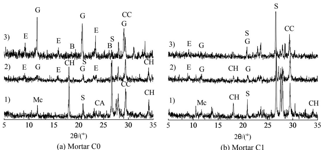
Fig. 2 - XRD patterns of the mortars before and after immersion in sulfate solutions with different temperatures. 1) before immersion; 2) at 5°C for 1 year; 3) at 20°C for 1 year. (E—ettringite and/or thaumasite; G—gypsum; CH—portlandite; Mc—monocarboaluminate; CC—calcite; S—quartz; B—Brucite) / Difractogramele mortarelor înainte și după imersia în soluție de sulfat de magneziu, la diferite temperaturi 1) înainte de imersie; 2) la 5°C, timp de un an; 3) la 20°C timp de un an.
