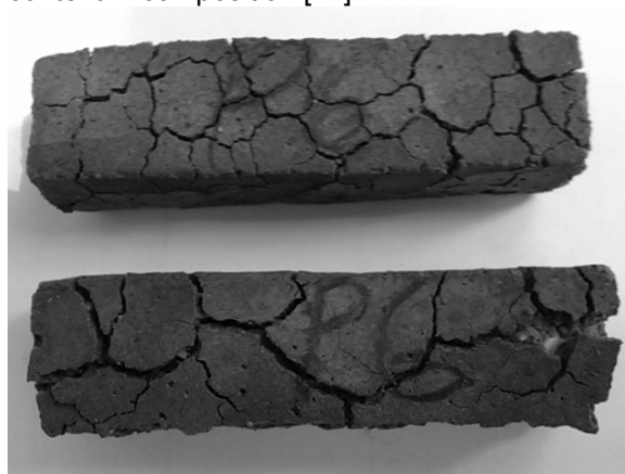
Fig. 12 - Expansiune cu fisurare, la întărirea timp de 7 zile a masei liante P_6 / Expansion with cracking at 7 days hardening of P_6 binding composition.
