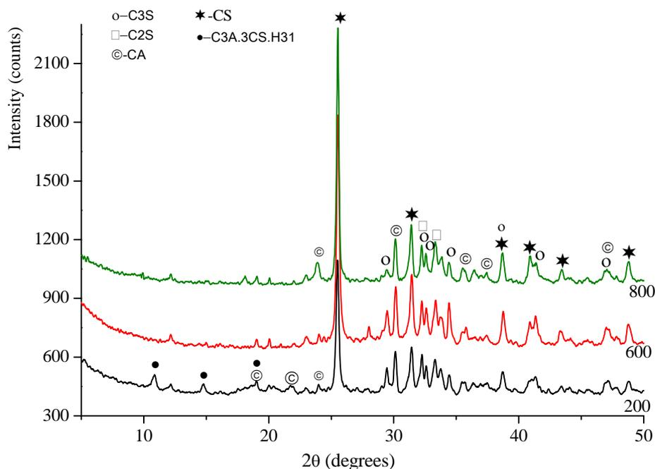
Fig. 5 - XRD patterns of P<sub>11</sub> binding composition, cured 7 days in normal conditions and after that, heat treated at 200, 600 and 800 Celsius degrees / Difractograme ale masei liante P<sub>11</sub>, întărită 7 zile în condiții normale și ulterior, tratată termic la temperaturi de 200, 600 și 800°C.
