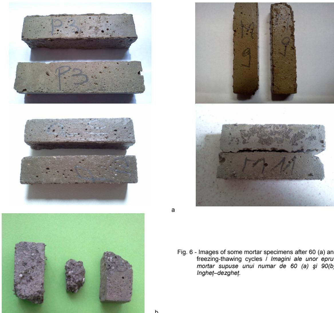
Fig. 6 - Images of some mortar specimens after 60 (a) and 90 (b) freezing-thawing cycles / Imagini ale unor epruvete de mortar supuse unui numar de 60 (a) și 90(b) cicluri îngheț-dezghet.
