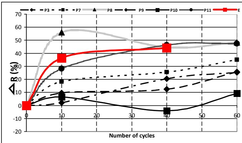
Fig. 8 - Strengths modifications of the binding specimens with anhydrite content, after 10, 40 and 60 freezing-thawing cycles / Modificări de rezistență ale probelor liante cu conținut de sulfat de calciu anhidru, după 10, 40 și 60 cicluri de îngheț – dezgheț: + diminishes / scăderi; - increases / creșteri .
