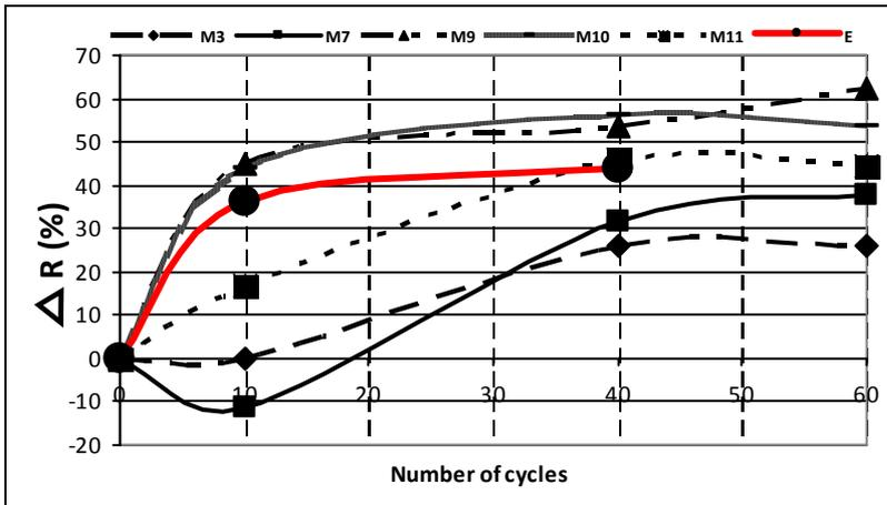
Fig. 7 - Strength modifications of the binding specimens with hemihydrate content after 10, 40 and 60 freezing-thawing cycles / Modificări de rezistență ale probelor liante cu conținut de sulfat de calciu semihidrat, după 10, 40 și 60 cicluri de îngheț – dezgheț: + diminishes / scăderi; - increases / creșteri .
