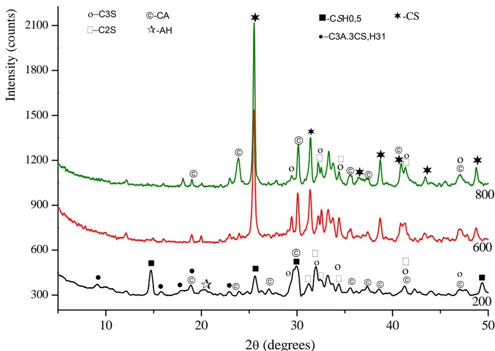
Fig. 4 - XRD patterns of M<sub>11</sub> binding composition, cured 7 days in normal conditions and after that, heat treated at 200, 600 and 800 Celsius degrees / Difractograme ale masei liante M<sub>11</sub>, întărită 7 zile în condiții normale și tratată termic ulterior, la temperaturi de 200, 600 și 800°C.
