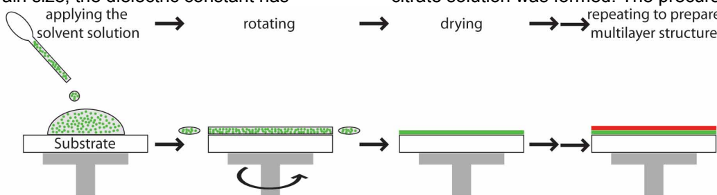
Fig. 1- The stages of the spin coating technique / Etapele tehnicii de depunere prin centrifugare.
