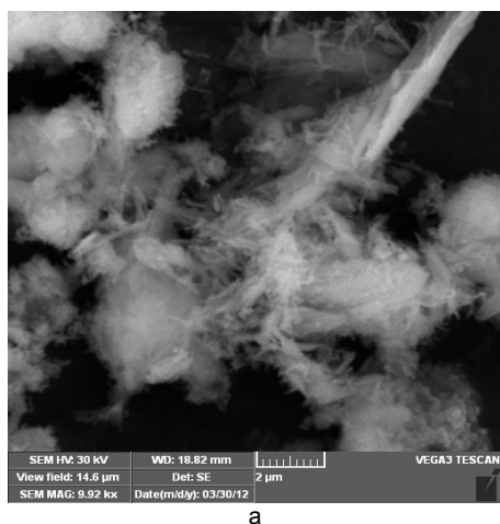
Fig. 5 - SEM micrographs of La_{0.95}Eu_{0.05}PO_4 obtained by method B using KH_2PO_4 : as-synthesized powder (a); annealed sample at 550°C/1h (b) / Imagini SEM pentru La_{0.95}Eu_{0.05}PO_4 obținut prin metoda B folosind KH_2PO_4 : pulberea sintetizată (a); proba tratată termic la 550°C/1h (b)
