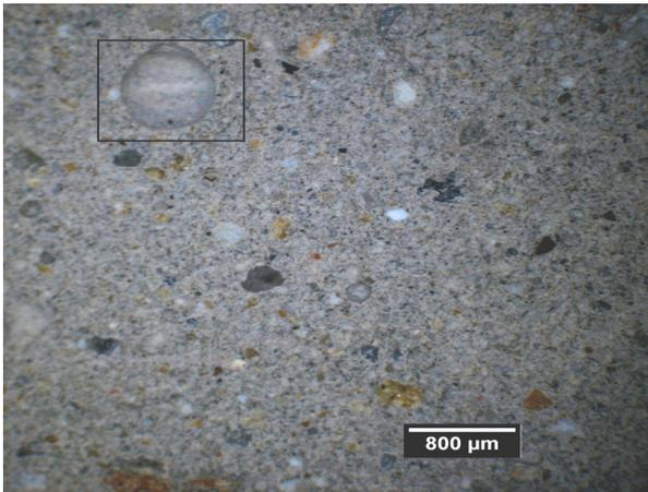
Fig. 12 - Fracture surface of the reference sample. Large void is indicated by rectangular shape / *Suprafața în ruptură a probei de referință. Forma rectangulară marchează un gol mare.*
