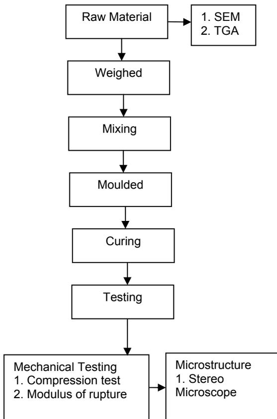
Fig. 1 - Flow chart of the development and characterisation of coconut fibre based-green composites / Succesiunea etapelor de obținere și caracterizare a compozitelor cu conținut de fibre de cocos.
