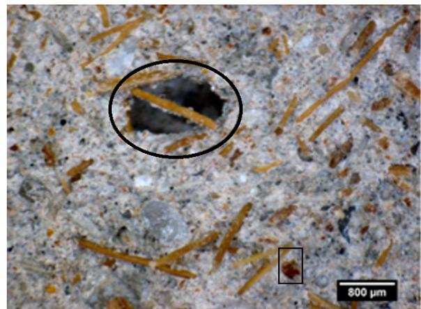
Fig. 15 - Large hole, fibre pull out, crack bridging and fibre push out on the fracture surface / *Gol mare, fibre smulse, fisuri interconectate și fibre îngropate la suprafața de rupere.*
