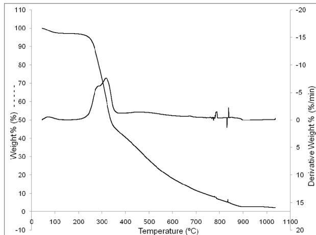
Fig. 8 -TGA and DTA analysis of coconut fibre / Rezultatul analizei TG și TD pe fibrele de cocos.
