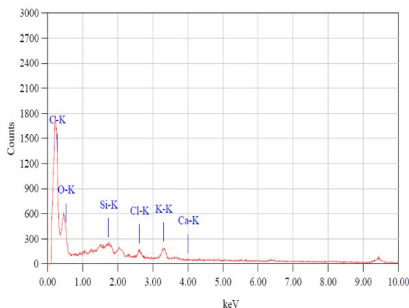
Fig. 4 - EDS spectrum for coconut fibre / Spectrul EDS realizat pentru fibrele de cocos.
