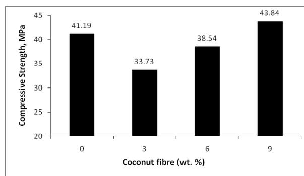
Fig. 11-Compressive strength of cement panel for 28 days curing / Rezistența la compresiune a compozitelor după 28 zile de întărire.
