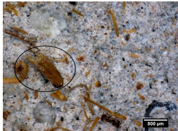
Fig. 14 - Fibre pulls out, fibre push out and small holes due to fibre pull out on the fracture surface / *Fibre smulse, îngropate și goluri lăsate de fibrele smulse în suprafața de ruptură*
