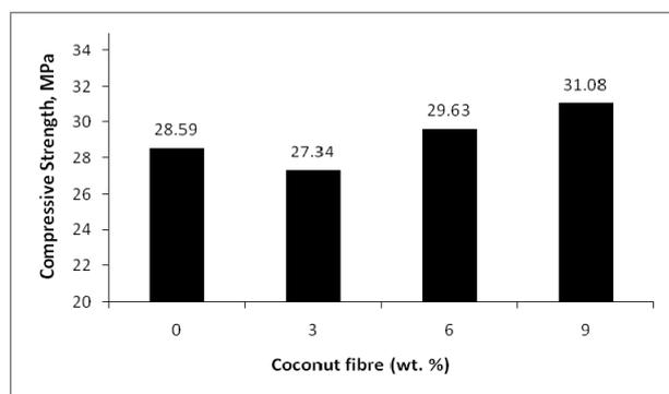
Fig. 9 - Compressive strength of cement panel for 7 days curing / Rezistența la compresiune a compozitelor după 7 zile de întărire.
