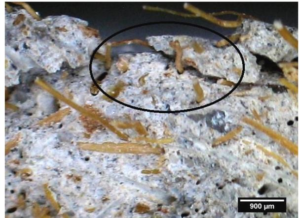
Fig. 13 - Crack bridging, small holes and long grooves on the fracture surface of composite cement reinforced with 9 wt. % of coconut fibre / *Interconectarea crăpăturilor, goluri mici și șanțuri lungi la suprafața de ruptură în cazul compozitului armat cu 9% fibre de cocos.*
