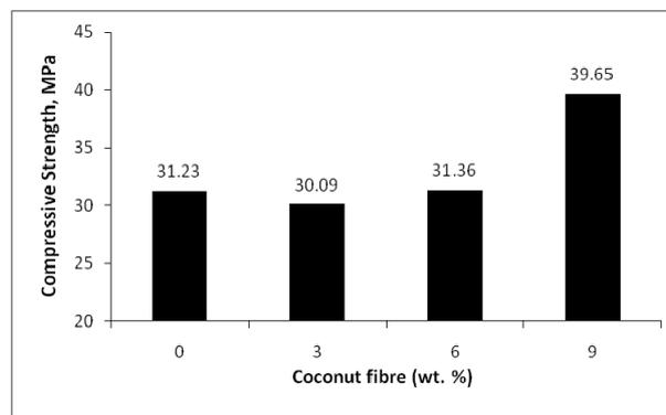
Fig. 10 - Compressive strength of cement panel for 14 days curing / Rezistența la compresiune a compozitelor după 14 zile de întărire.
