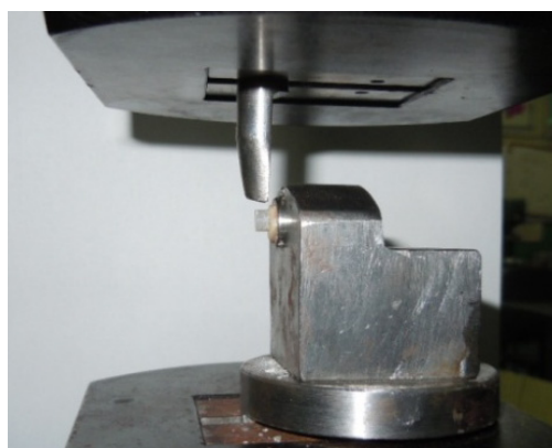
Fig.2 - Testarea rezistenței la forfecare a interfețelor. The shear bond strength test.
