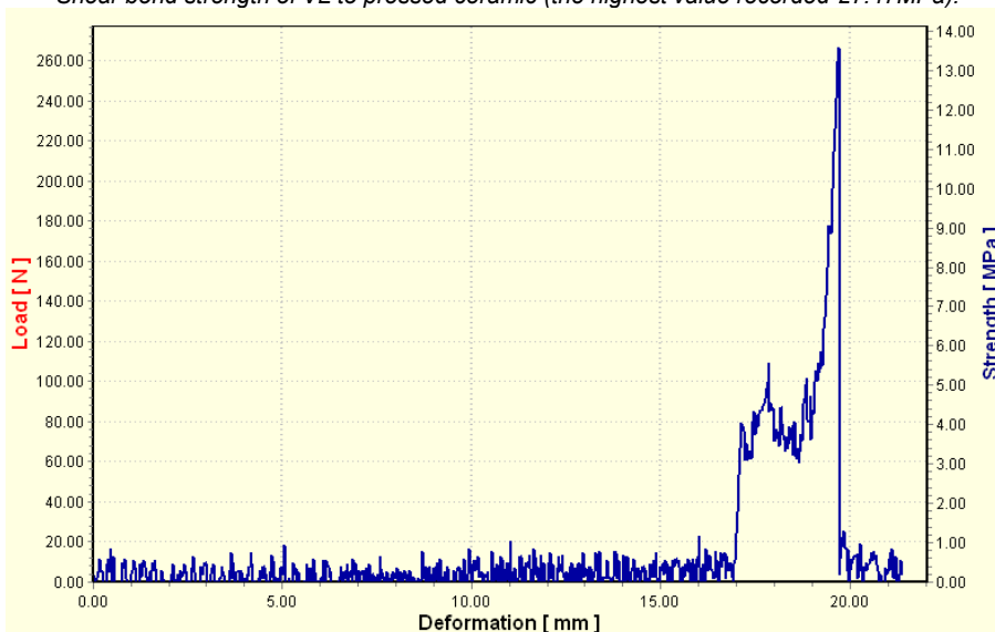
Fig. 7 - Rezistența la forfecare a interfeței BC-zirconA (valoarea maximă -13,58 MPa). Shear bond strength of ME to zirconia (the maximum value -13.58 MPa).
