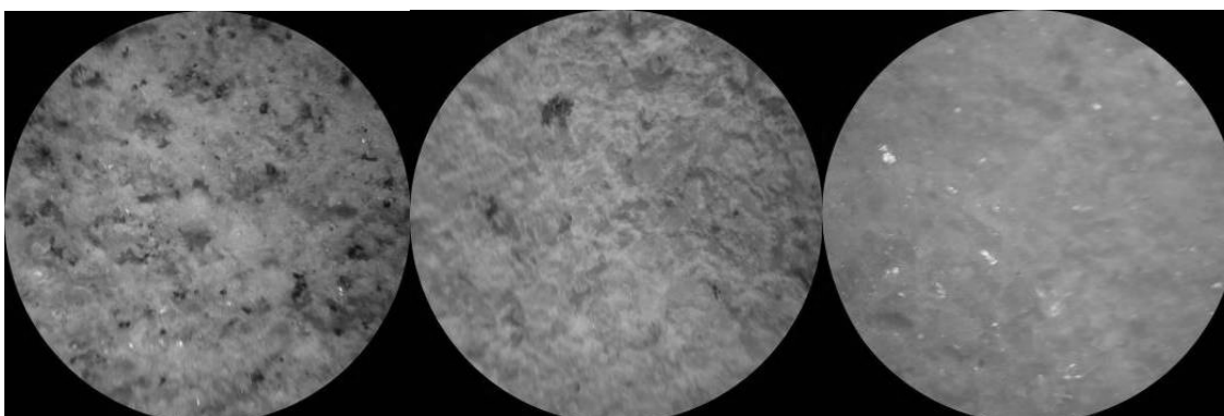
Fig. 2 - Images of SC concrete after thermal treatment at 110, 800 and 1500 °C for IPP analysis / Imagini de microscopie optică ale structurii betonului SC după tratamentul termic la 110, 800 și 1500 °C, conform programului IPP.
