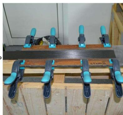
Fig. 1- Rig for controlling the adhesive thickness / Dispozitiv folosit pentru controlul grosimii adezivului.
