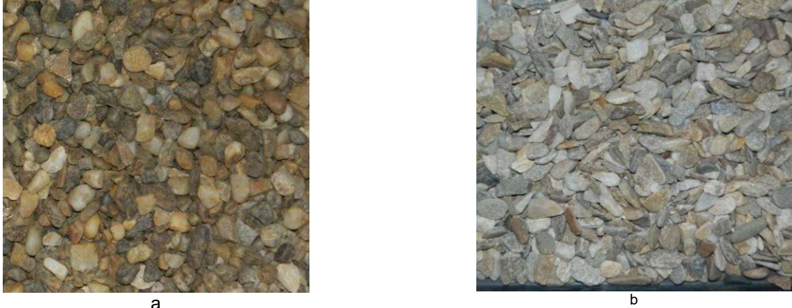
Fig. 1 - Polyhedral (a) and flat (b) aggregates (fraction 8/16 mm) / Agregate poliedrale (a) și plate (b) – fracțiunea 8/16 mm.
