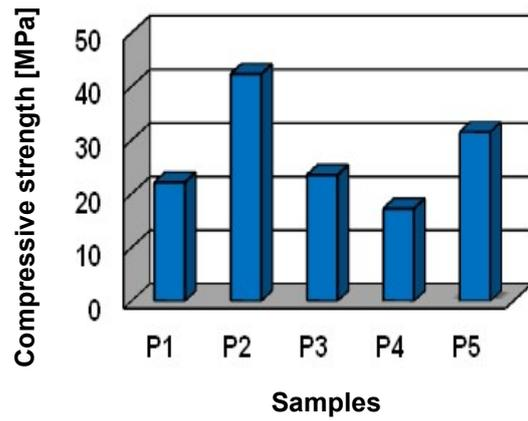
Fig. 5- Compressive strength values for the five obtained oxide materials / Valorile rezistenței mecanice la compresiune pentru cele 5 materiale oxidice elaborate.
