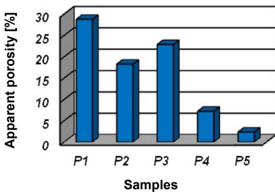
Fig. 7- Apparent porosity values for the five obtained oxide materials / Valorile de porozitate aparentă pentru cele 5 materiale oxidice elaborate
