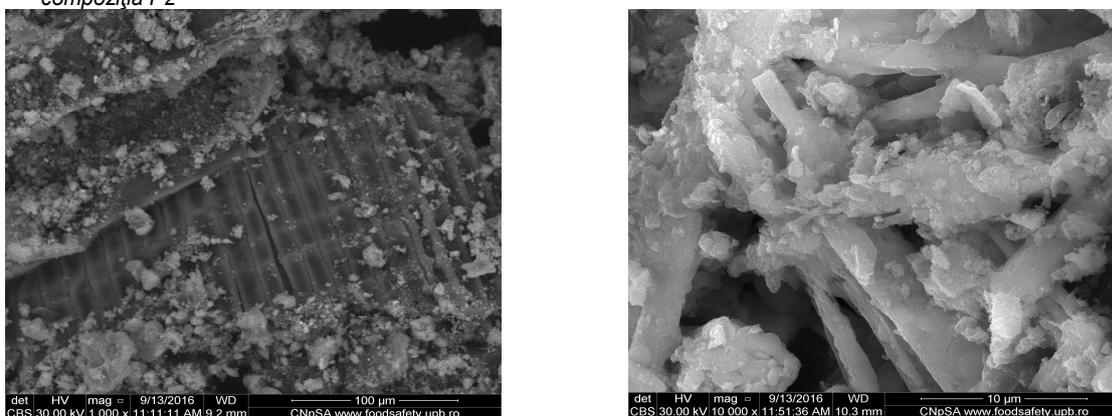
Fig. 11. - SEM micrographs (magnification 1000X and 10000X) for P3 composition / Înregistrările SEM (mag. 1000X și 10000X) pentru compoziția P3
