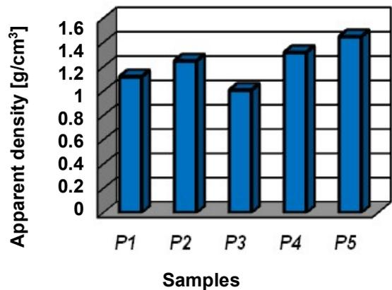
Fig. 6 - Apparent density values for the five obtained oxide materials / Valorile densității aparente pentru cele 5 materiale oxidice elaborate.
