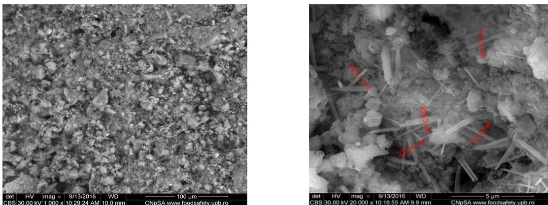
Fig. 9 - SEM micrographs (magnification 1000X and 20000X) for P1 composition / Înregistrările SEM (mag.1000X și 20000X) pentru compoziția P1
