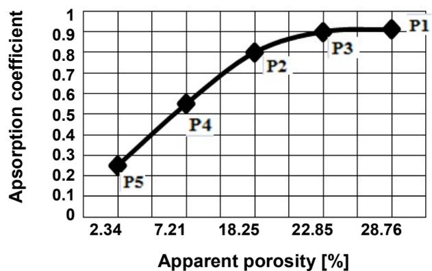
Fig.8 - The variation of the sound absorption coefficient versus the apparent porosity for the 5 obtained oxide materials / Variația coeficientului de absorbție a undelor sonore versus porozitate aparentă pentru cele 5 materiale oxidice elaborate.
