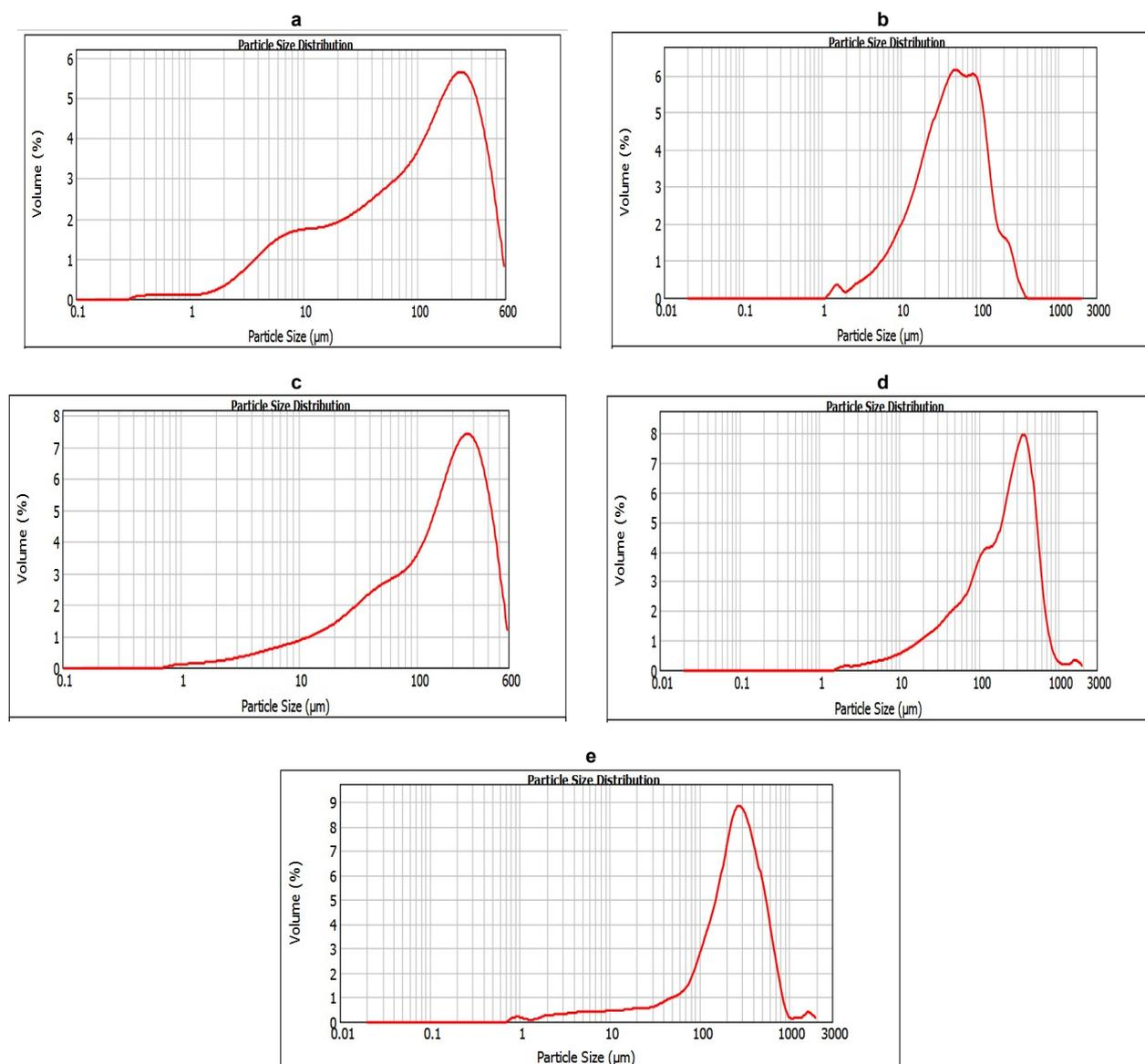
Fig. 1. - Particle size distribution for the fine fractions of the wastes: (a) – ash from burning seed shells; (b) – fly ash; (c) – sterilized waste garbage; (d) – steel works slag; (e) – thermal power plant slag / Distribuțiile granulometrice pentru fracțiile fine ale deșeurilor: (a) – cenușă coji; (b) – cenușă termocentrală; (c) – deșeu steril menajer; (d) – zgură de oțelărie; (e) – zgură de termocentrală.
