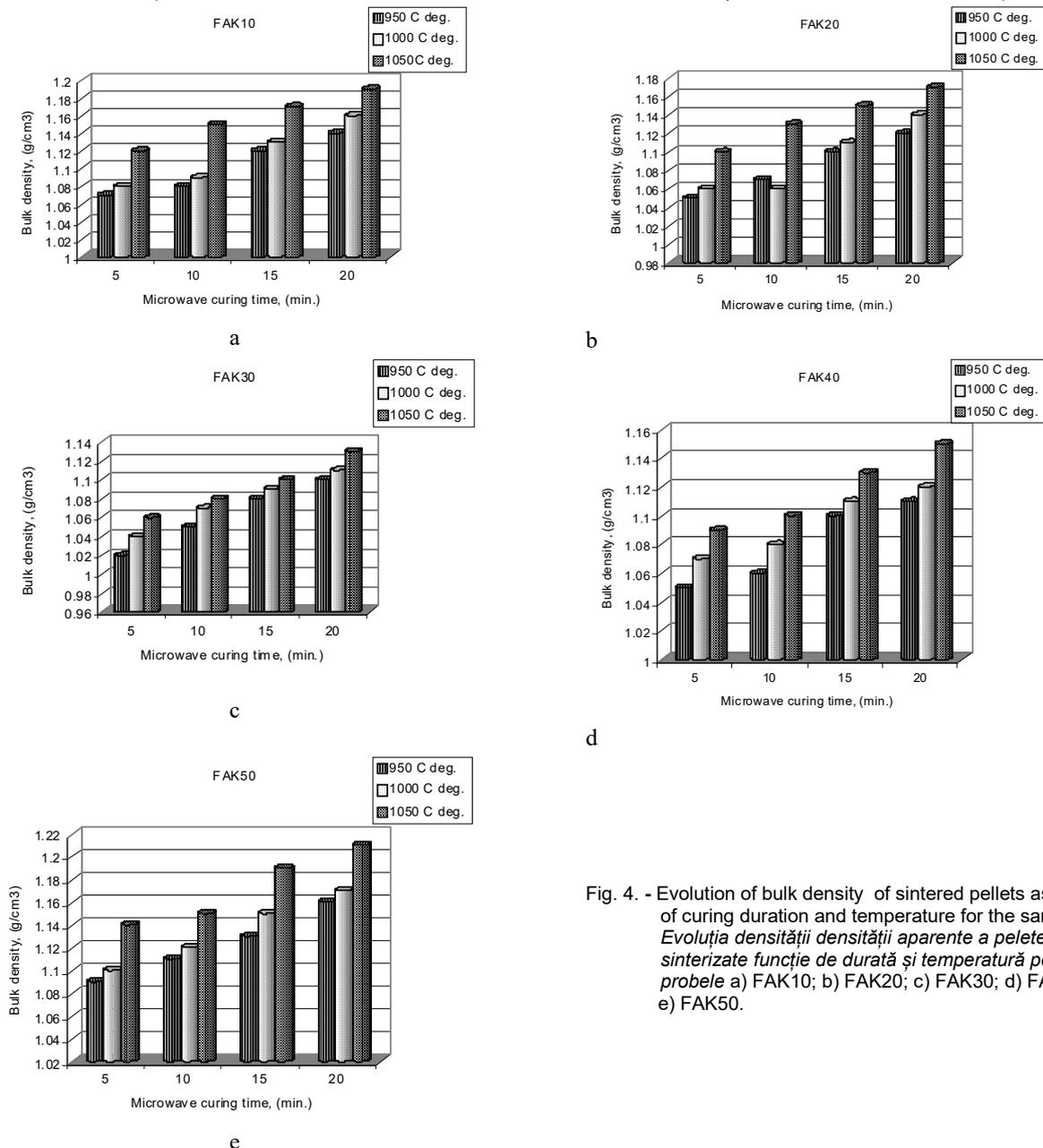
Fig. 4. - Evolution of bulk density of sintered pellets as function of curing duration and temperature for the samples: *Evoluția densității aparente a peletelor sinterizate funcție de durată și temperatură pentru probele a) FAK10; b) FAK20; c) FAK30; d) FAK40; e) FAK50.*
