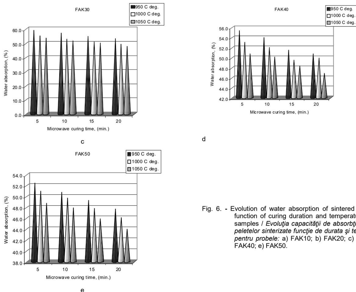
Fig. 6. - Evolution of water absorption of sintered pellets as function of curing duration and temperature for the samples / Evoluția capacității de absorbție a apei a peletelor sinterizate funcție de durata și temperatura pentru probele: a) FAK10; b) FAK20; c) FAK30; d) FAK40; e) FAK50.
