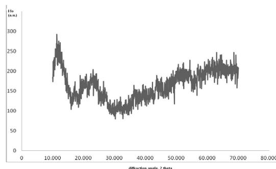
Fig.1 - XRD pattern of F class fly ash / *Diffractograma cenuşii de termocentrală (clasa F)*.
