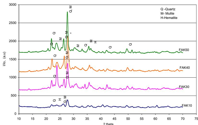
Fig.7 - XRD spectra pattern of lightweight ceramics FAK10, FAK30, FAK40 and FAK50 sintered at 1050 °C for 20 minutes in microwaves / Diffractograma ceramicilor ușoare FAK10, FAK30, FAK40 și FAK50 sinterizate la 1050 °C timp de 20 minute în câmp de microunde
