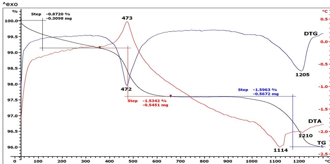
Fig. 2a - TG/DTA diagram for class F fly ash / Diagrama TG / DTA a cenușii de termocentrală (clasa F).
