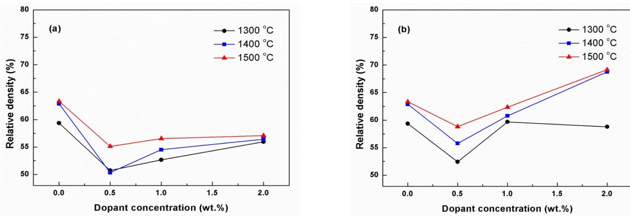
Fig. 1 - Variation of relative density of SnO<sub>2</sub> based ceramics as a function of sintering temperature and dopant quantity for La<sup>3+</sup> (a) and V<sup>5+</sup> (b) / Variația densității relative a ceramicilor pe bază de SnO<sub>2</sub> în funcție de temperatura de sinterizare și cantitatea de dopant pentru La<sup>3+</sup> (a) și V<sup>5+</sup> (b).
