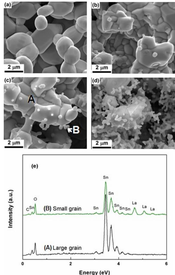
Fig. 5 - SEM images of SnO<sub>2</sub> based ceramics sintered at 1400°C and doped with La<sup>3+</sup>: 0.0 wt.% (a), 0.5 wt.% (b), 1.0wt.% (c) and 2.0 wt.% (d), and EDX spectra obtained on the sample doped with 1.0wt.% La<sup>3+</sup> / Imagini SEM ale ceramicilor pe bază de SnO<sub>2</sub> sinterizate la 1400°C și dopate cu La<sup>3+</sup>: 0,0 % grav. (a), 0,5 % grav. (b), 1,0 %grav. (c) și 2,0 % grav. (d), și spectrele EDX realizate pe proba dopată cu 1,0 grav.% La<sup>3+</sup> (e).
