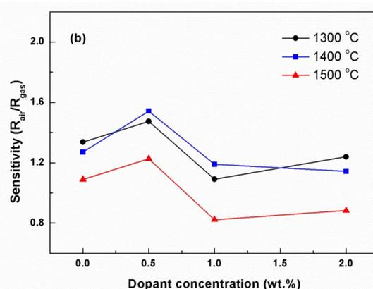
Fig. 8 - Variation of sensitivity to methane (a) and isopropyl alcohol vapours (b) of SnO<sub>2</sub> based ceramics as a function of sintering temperature and V<sup>5+</sup> dopant quantity / Variația sensibilității la metan (a) și vapori de alcool izopropilic (b) a ceramicilor pe bază de SnO<sub>2</sub> în funcție de temperatura de sinterizare și cantitatea de dopant V<sup>5+</sup>.
