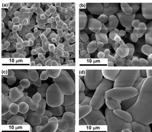
Fig. 6 - SEM images of SnO<sub>2</sub> based ceramics sintered at 1400°C and doped with V<sup>5+</sup>: 0.0 wt.% (a), 0.5 wt.% (b), 1.0 wt.% (c) and 2.0 wt.% (d) / Imagini SEM ale ceramicilor pe bază de SnO<sub>2</sub> sinterizate la 1400°C și dopate cu V<sup>5+</sup>: 0,0 % grav. (a), 0,5 % grav. (b), 1,0 % grav. (c) și 2,0 % grav. (d).
