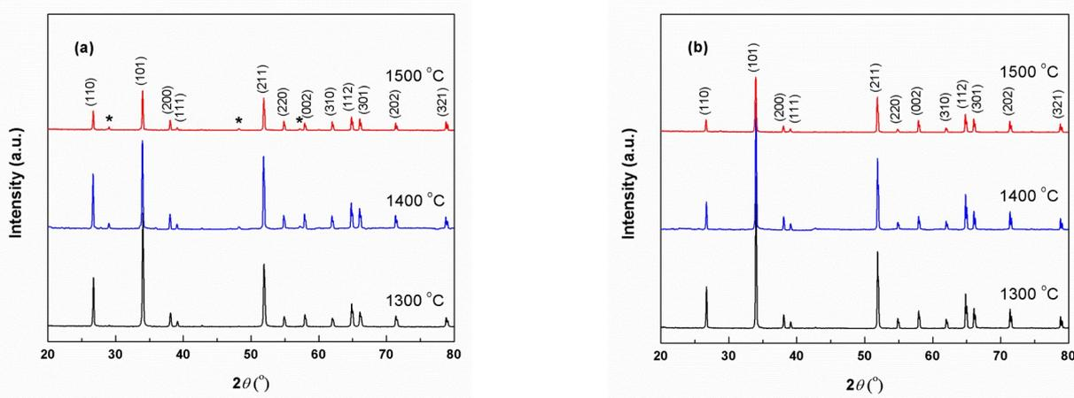
Fig. 2 - XRD patterns for SnO<sub>2</sub> based sintered ceramics and doped with 0.5 wt.% La<sup>3+</sup> (a) and V<sup>5+</sup> (b). \* indicates the secondary phase / Analizele de difracție a razelor X pentru ceramicile pe bază de SnO<sub>2</sub> sinterizate și dopate cu 0,5 % grav. La<sup>3+</sup> (a) și V<sup>5+</sup> (b). \* indică faza secundară.
