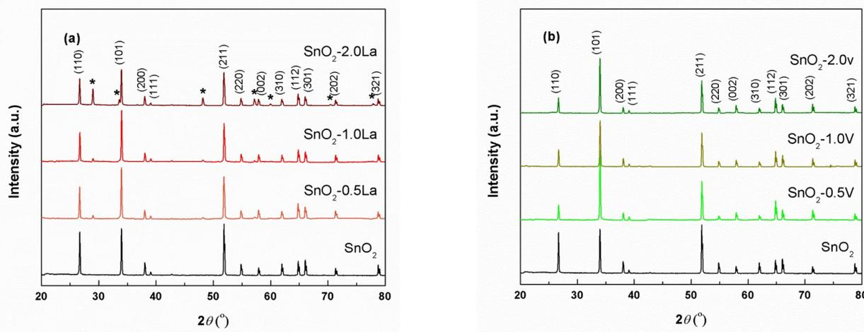
Fig. 3 - XRD patterns for SnO<sub>2</sub> based ceramics sintered at 1400 °C and doped with La<sup>3+</sup> (a) and V<sup>5+</sup> (b). \* indicates the secondary phase / Analizele de difracție a razelor X pentru ceramicile pe bază de SnO<sub>2</sub> sinterizate la 1400 °C și dopate cu La<sup>3+</sup> (a) și V<sup>5+</sup> (b). \* indică faza secundară.
