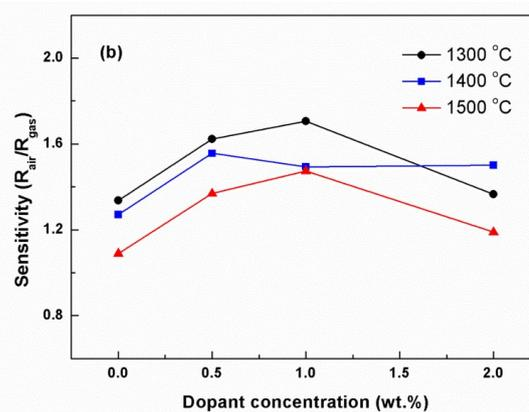
Fig. 7 - Variation of sensitivity to methane (a) and isopropyl alcohol vapours (b) of SnO<sub>2</sub> based ceramics as a function of sintering temperature and La<sup>3+</sup> dopant quantity / Variația sensibilității la metan (a) și vapori de alcool izopropilic (b) a ceramicilor pe bază de SnO<sub>2</sub> în funcție de temperatura de sinterizare și cantitatea de dopant La<sup>3+</sup>.
