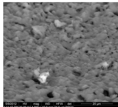
B2) SEM images of ceramic sample in fracture obtained at 1200°C / B2) Imagini MEB obținute în fractura probei ceramice sinterizate la 1200°C.
