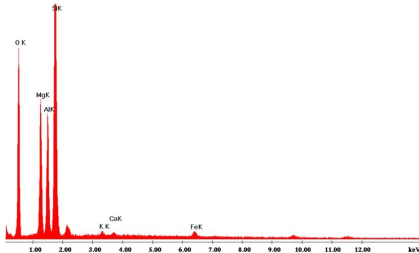
Fig. 7- EDX spectrum associated with ceramic sample sintered at 1100°C / Spectru EDX obținut pe proba ceramică sinterizată la 1100°C
