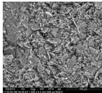
A2) SEM images of ceramic sample in fracture obtained 1100°C / A2) Imagini MEB obținute în fractura probei ceramice sinterizate la 1100°C.
