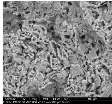
C2) SEM images of ceramic sample in fracture obtained at 1300°C / C2) Imagini MEB obținute în fractura probei ceramice sinterizate la 1300°C
