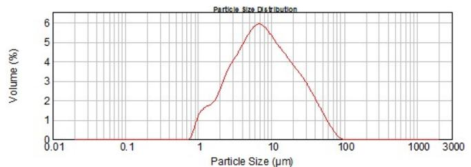
Fig.2- Granulometric distribution of ceramic powder heat treated at 1000°C / *Distribuția granulometrică a pulberii ceramice tratată termic la 1000°C.*
