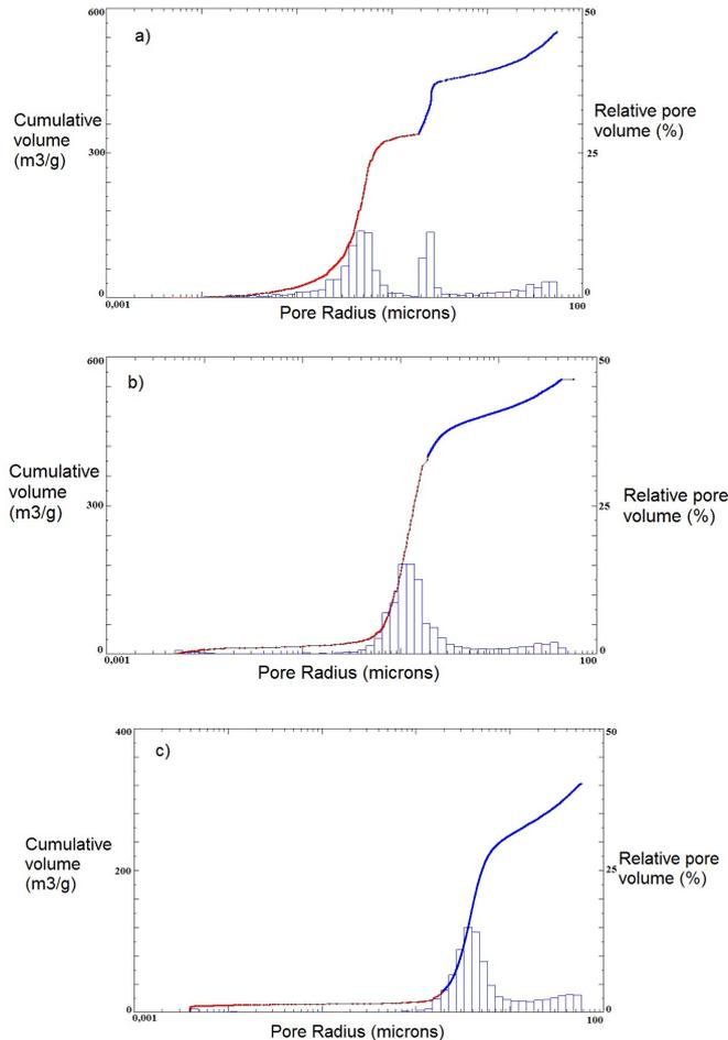
Fig. 5 - Pore size distribution of sintered materials at: a) 1100°C, b) 1200°C and c) 1300°C / *Distribuția granulometrică a porilor pentru materialele sinterizate: a) 1100°C, b) 1200°C, c) 1300°C.*
