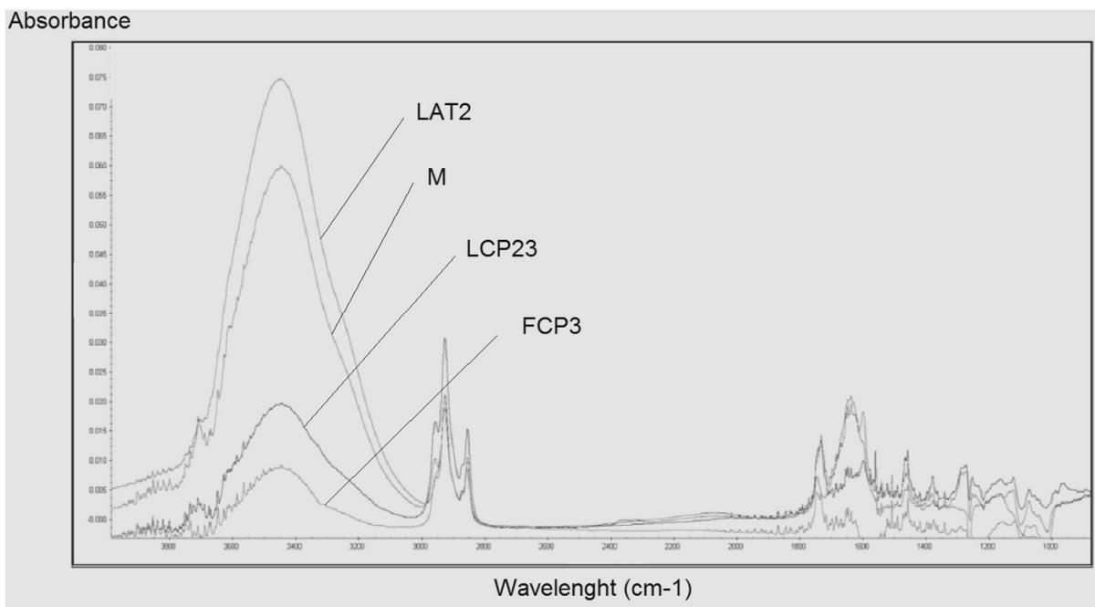
Fig. 9- FT-IR absorption spectrum of biosupport samples and control sample / Spectru de absorbție FTIR pentru probele cu biofilm și proba control.
