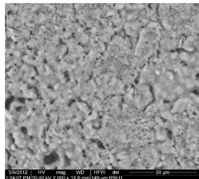
B1) SEM images of ceramic sample surface obtained at 1200°C / B1) Imagini MEB obținute pe suprafața probei ceramice sinterizate la 1200°C.
