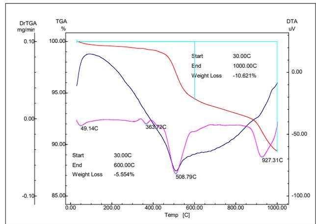
Fig. 1- Thermal analysis of kaolin/talc mixture / *Analiza termică a amestecului caolin/talc.*
