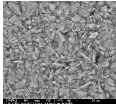
A1) SEM images of ceramic sample surface obtained at 1100°C / A1) Imagini MEB obținute pe suprafața probei ceramice sinterizate la 1100°C.
