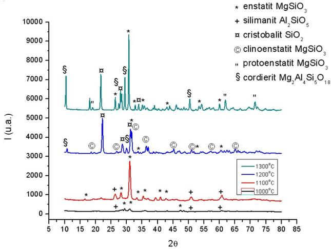
Fig.4- X-ray diffraction spectra of calcined and heat treated ceramic powder at 1100-1300°C / *Difracțograme de raze X obținute pe pulberile ceramice calcinate și tratate termic la temperaturi cuprinse între 1100 – 1300°C.*
