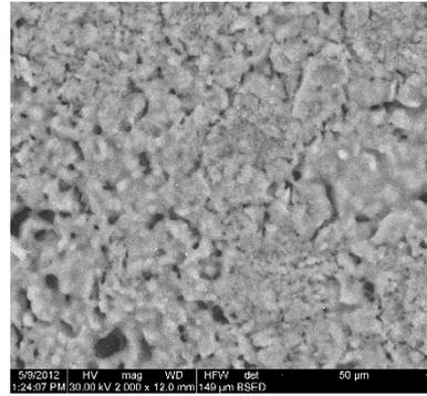
C1) SEM images of ceramic sample surface obtained at 1300°C / C1) Imagini MEB obținute pe suprafața probei ceramice sinterizate la 1300°C
