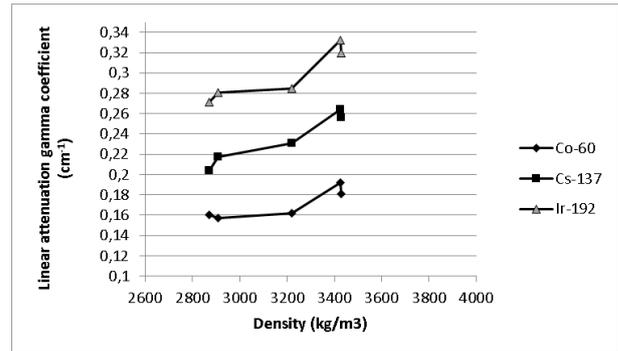
Fig. 6 - Linear attenuation coefficient vs concrete density/ *Coeficientul linear de atenuare în corelație cu densitatea.*
