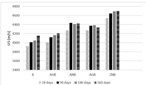
Fig. 5 - The ultrasonic pulse velocity evolution of the concretes/ *Evoluția vitezei de propagare a ultrasunetelor.*
