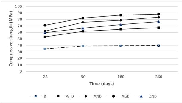
Fig. 4 - The compressive strengths evolution of the concretes in time/ *Evoluția rezistenței la compresiune a betoanelor în timp.*
