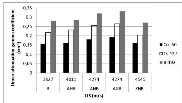
Fig. 7 - Linear attenuation coefficient vs concrete ultrasonic velocity pulse / *Coeficientul linear de atenuare în corelație cu viteza de propagare a ultrasunetelor.*
