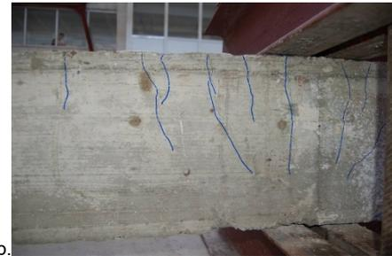
Fig. 4 - a. Beam G1 loaded until failure / Grinda G1 solicitată până la cedare; b. Crack pattern of G1 beam / Ansamblu de fisuri în grinda G1.
