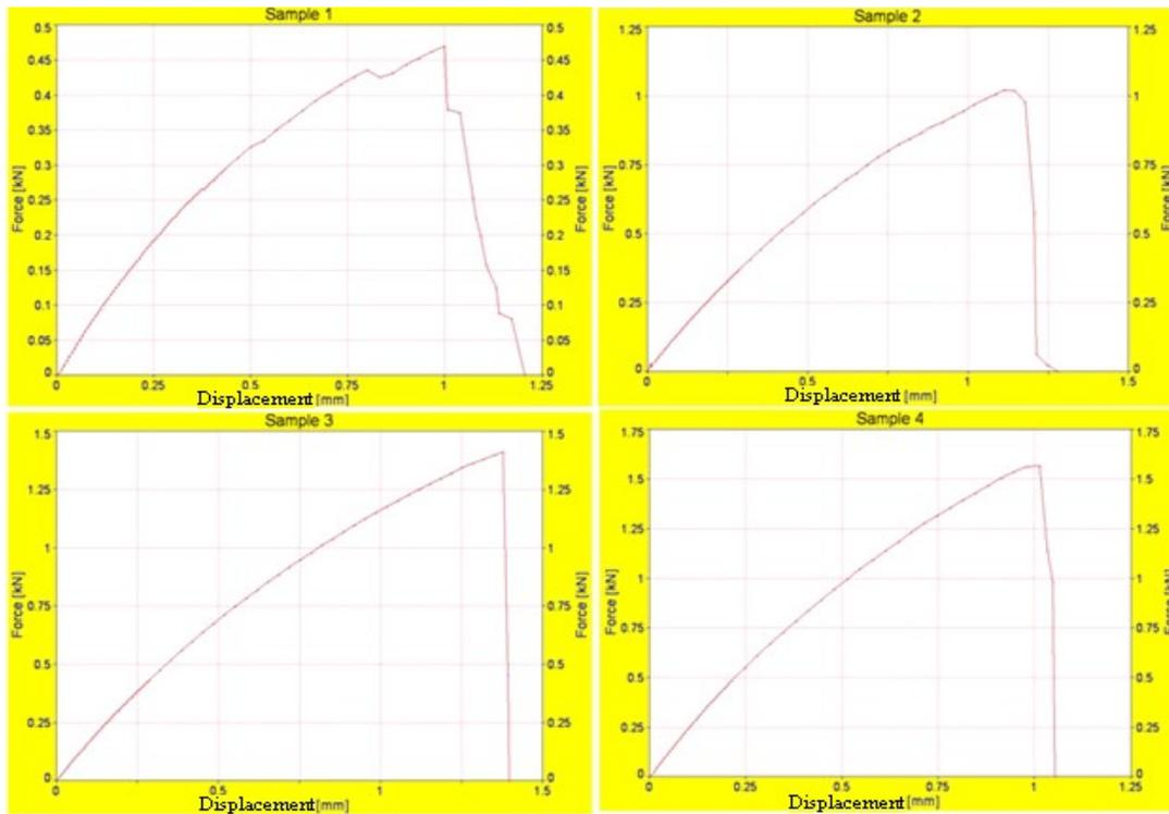
Fig. 4 - The stress-strain curves for all the samples / Curbele tensiune-deformație specifică pentru toate epruvetele.
