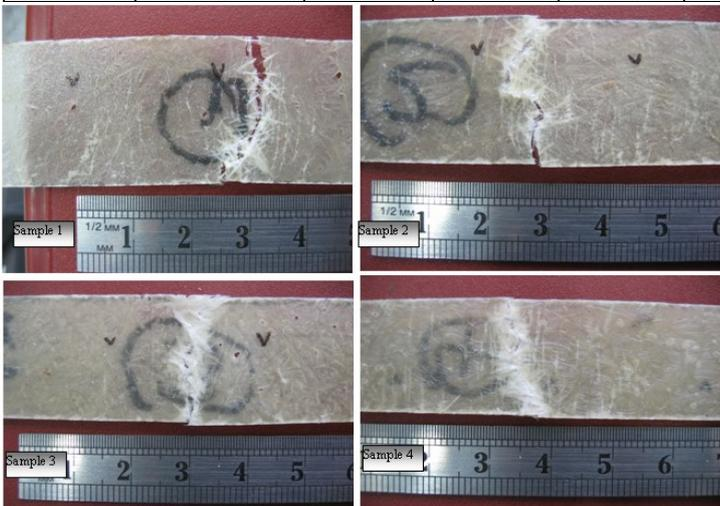
Fig. 5 - Macroscopic fracture section shape of the samples from the tensile test / Forma secțiunii de rupere la nivel macroscopic din solicitarea la tracțiune.
