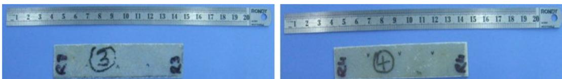
Fig. 3 - Tensile test samples / *Epruvetele supuse la tracțiune.*
