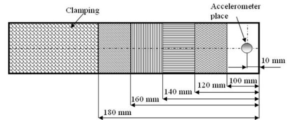
Fig. 7 - Experimental setup / Montaj experimental.
