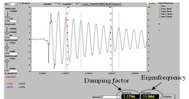
Fig. 9 - Experimental determinations for the sample 4 damping factor and eigenfrequency / Determinări experimentale ale factorului de amortizare și frecvenței proprii pentru epruveta 4.
