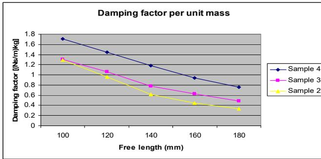
Fig. 10 - Damping factor per unit mass variation with the free length / *Variația factorului de amortizare pe unitatea de masă cu lungimea liberă a epruvetelor.*
