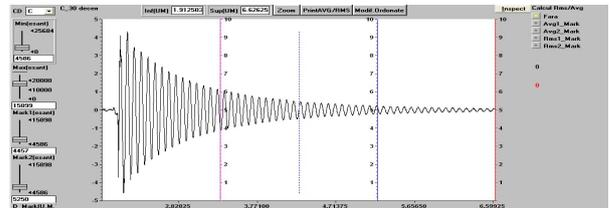
Fig. 8 - Experimental recordings for the sample 4, with the free length of 140 mm / Înregistrare experimentală pentru epruveta 4, având lungimea liberă de 140 mm.
