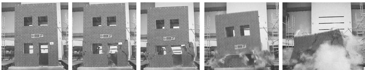
Fig. 1 - Collapse mechanisms observed on full-scale test / Mecanismul de colaps pentru modelul la scară reală.
