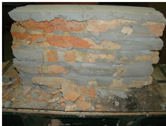
Fig. 11 - Caracteristici ale cedării la compresiune ale probelor din zidărie având rosturile consolidate cu mortar de ciment armat dispers cu fibre polipropilenice/ Compressive failure features of the masonry units strengthened with polypropylene fibres reinforced mortar.
