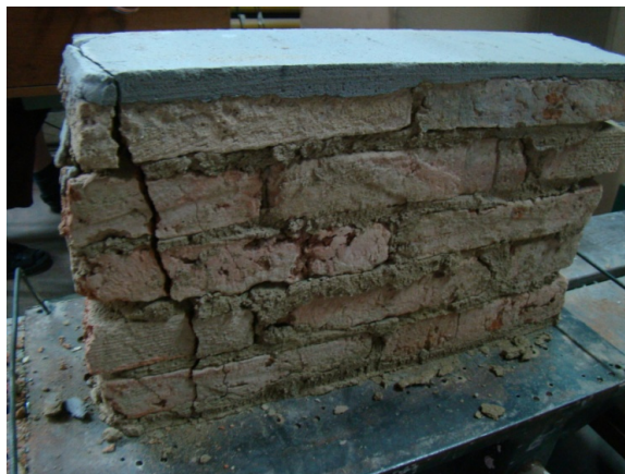
Fig. 7 - Cedarea la compresiune a probelor martor, din zidărie neconsolidată, cu mortar de argilă/ Compressive failure of the unstrengthened control units, with clay mortar.
