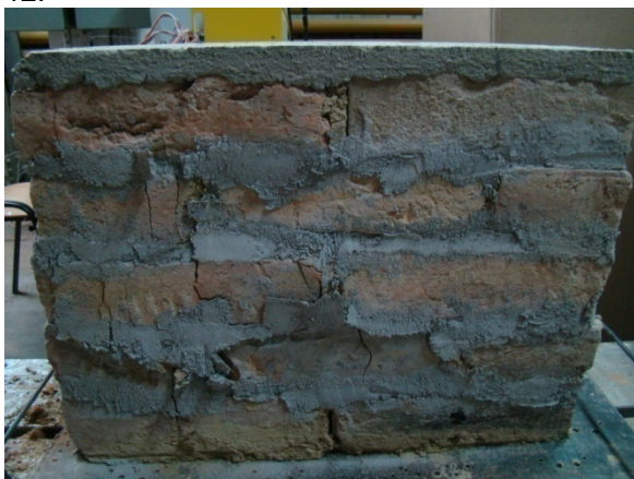
Fig. 10 - Caracteristici ale cedării la compresiune ale probelor din zidărie având rosturile consolidate cu mortar de ciment și FlexCement/ Compressive failure features of the masonry units strengthened with mortar improved with FlexCement.
