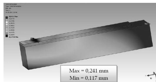
Fig. 12 - The relative displacement for C2 series / Deplasarea relativă pentru seria de probe C2.
