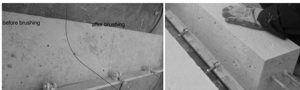
Fig. 3 - The surface of the specimens prepared for strengthening / Suprafața probelor pregătite pentru consolidare.
