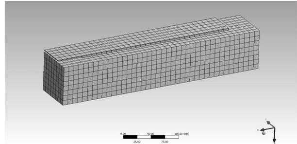
Fig. 10 - The finite element mesh / Rețeaua de elemente finite.
