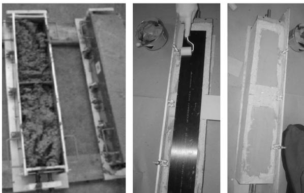
Fig. 2 - The specimen manufacturing / Confecționarea probei.
