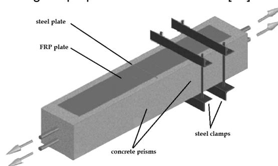
Fig. 1 - The test specimen / Probă experimentală.
