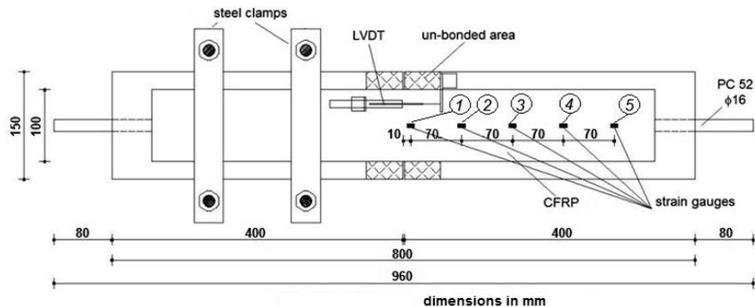
Fig. 5. Specimen instrumentation with LVDTs and strain gauges / *Instrumentarea probelor cu traductori de deplasare și rezistivi.*
