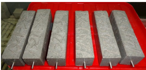
Fig. 4 – The expansion of the mortars maintained in moderate sulphatic environment, XA2 class of exposure/ Expansiunea mortarelor menținute în mediu sulfatic moderat, clasa de expunere XA2.
