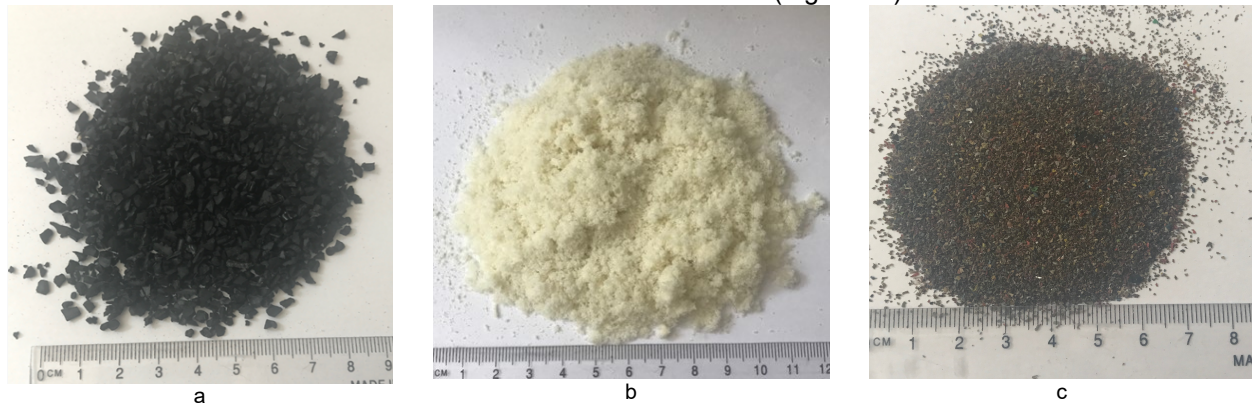
Fig.1 – Waste rubber (a), polyurethane foam waste (b) and chopped electrical cable (c) / Deșeu de cauciuc (a), deșeu de spumă poliuretanică (b) și deșeu de cabluri electrice tocate (c).
