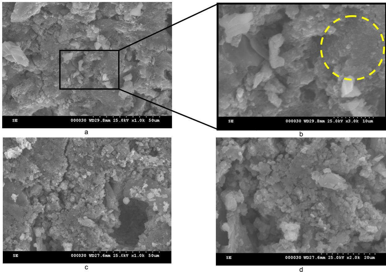
Fig. 11 - SEM micrographs of mortar specimens immersed 28 days in demineralized water a,b-B-N5, c,d- BR25-N5/ Imagini obținute prin microscopie de baleiaj ale probelor de mortar după 28 de zile de imersare în apă a,b-B-N5, c,d-BR25-N5.
