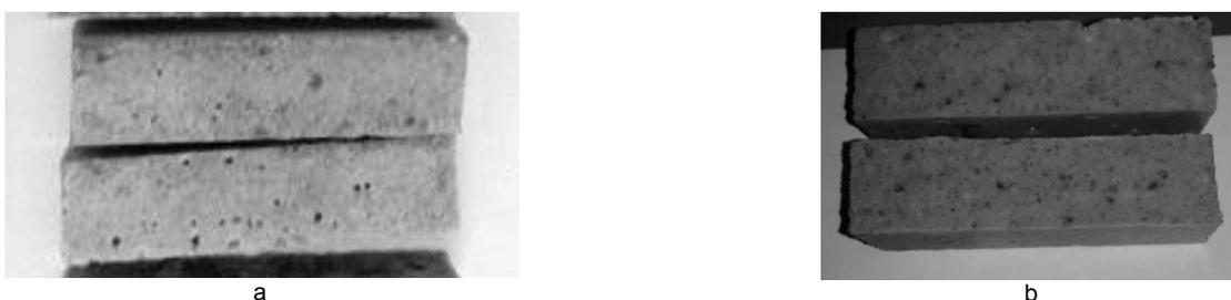
Fig. 8 - Visual aspect of B-N5: a) before immersion test; b) after immersion in water for 28 days / Aspectul vizual al B-N5:a) înainte de testul de imersie; b) după imersarea în apă timp de 28 zile.
