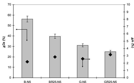
Fig. 10 - Compressive strength loss ( $\Delta C_s$ ) and mass loss ( $\Delta m$ ) after 28 days of immersion in water / Pierderea de rezistență la compresiune ( $\Delta C_s$ ) și de masă ( $\Delta m$ ) după 28 de zile de imersare a probelor în apă.
