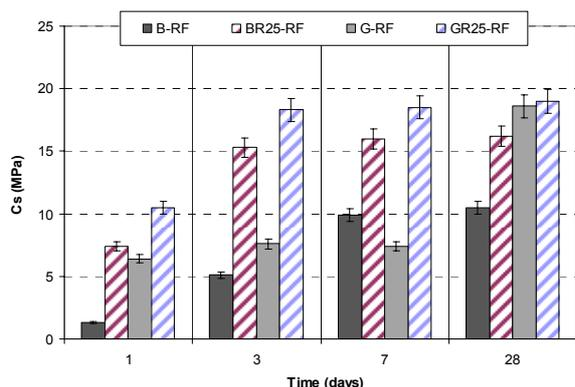
Fig.3 - Compressive strengths developed by the geopolymers based on brown glass powder (B), brown glass powder with 25% red mud powder (BR25), green glass powder (G) and green glass powder with 25% red mud powder (GR25), activated with RF solution/ *Rezistența la compresiune dezvoltată de geopolimerii pe bază de sticlă brună (B), sticlă brună cu 25% șlam roșu (BR25), sticlă verde (G) și sticlă verde cu 25% șlam roșu (GR25) activate cu soluție RF.*
