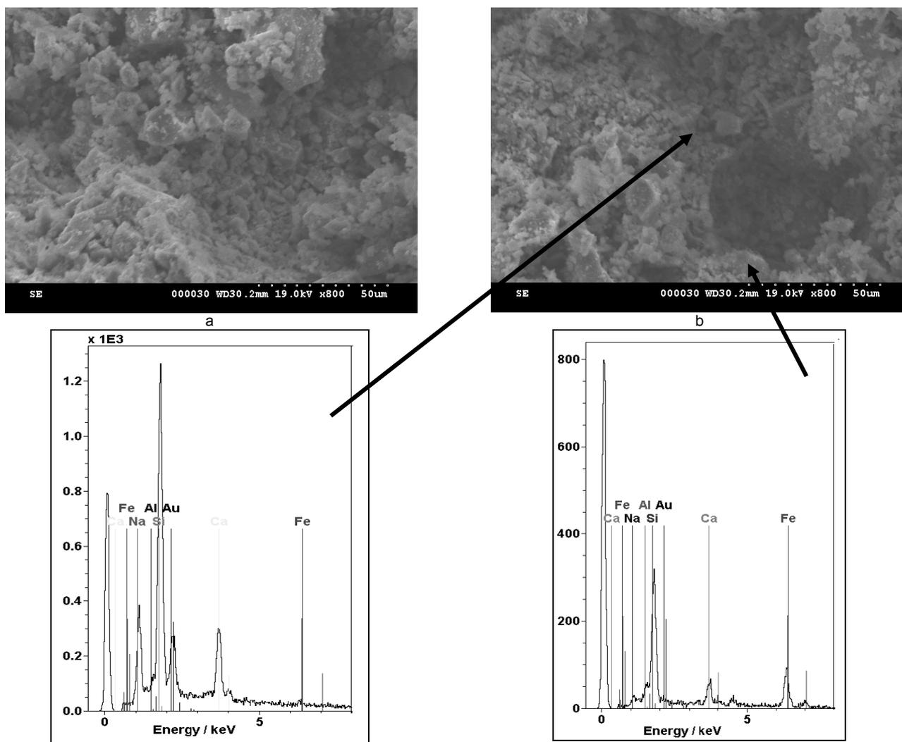
Fig.7 - SEM micrographs (a,b) and EDX analysis (c,d) of BR25-RF specimen after 7 days of curing / Imagini de microscopie electronică de baleiaj (a,b) și spectroscopie de raze X cu dispersie de energie (c,d) a probei BR25- RF5 după 7 zile de întărire.
