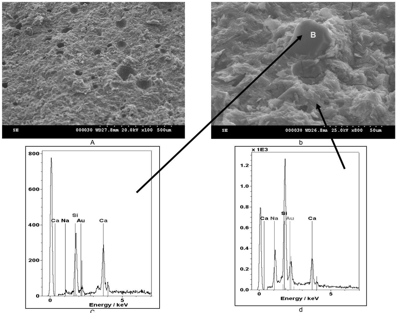
Fig.5 - SEM micrographs (a,b) and EDX spectra (c,d) of B-N5 specimen after 7 days of curing / Imagini de microscopie electronică de baleiaj (a,b) și spectroscopie de raze X cu dispersie de energie (c,d) a probei B-N5 după 7 zile de întărire.
