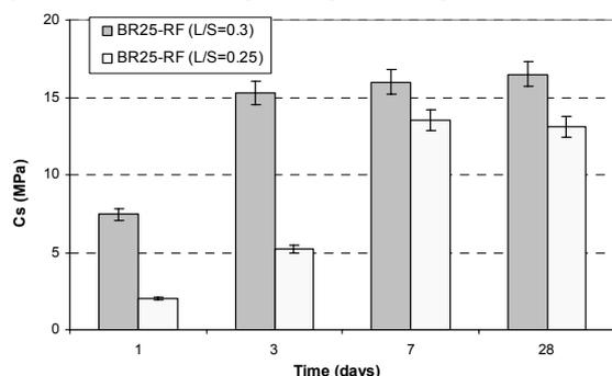
Fig.4 - Influence of liquid to solid ratio (L/S) on the compressive strength values developed by the geopolymers based on brown glass powder with 25% red mud powder (BR25), activated RF solution, cured for 3 days at 60°C and then in air at 20°C/ *Influența raportului lichid/solid (L/S) asupra valorilor rezistenței la compresiune dezvoltată de geopolimerii pe bază de sticlă brună cu 25% șlam roșu (BR25), activate cu soluție RF și păstrate primele 3 zile în aer la 60°C și apoi în aer la 20°C.*
