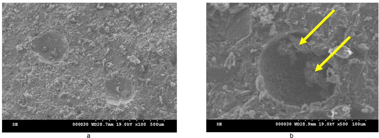
Fig.6 - SEM micrographs of BR25-N5 specimen after 7 days of curing / Imagini obținute prin microscopie electronică de baleiaj a probei BR25-N5 după 7 zile de întărire.
