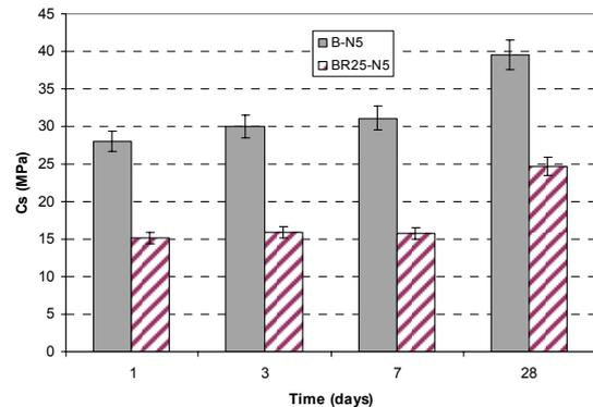
Fig.2 - Compressive strength vs. time for geopolymers based on brown glass powder (B) and mixtures of brown glass powder with 25% red mud (BR25) activated with NaOH 5M (N5) / Variația în timp a rezistenței la compresiune a geopolimerilor pe bază de sticlă brună (B) și amestecuri de sticlă brună cu 25% șlam roșu (BR25) activate cu soluție NaOH 5M (N5).
