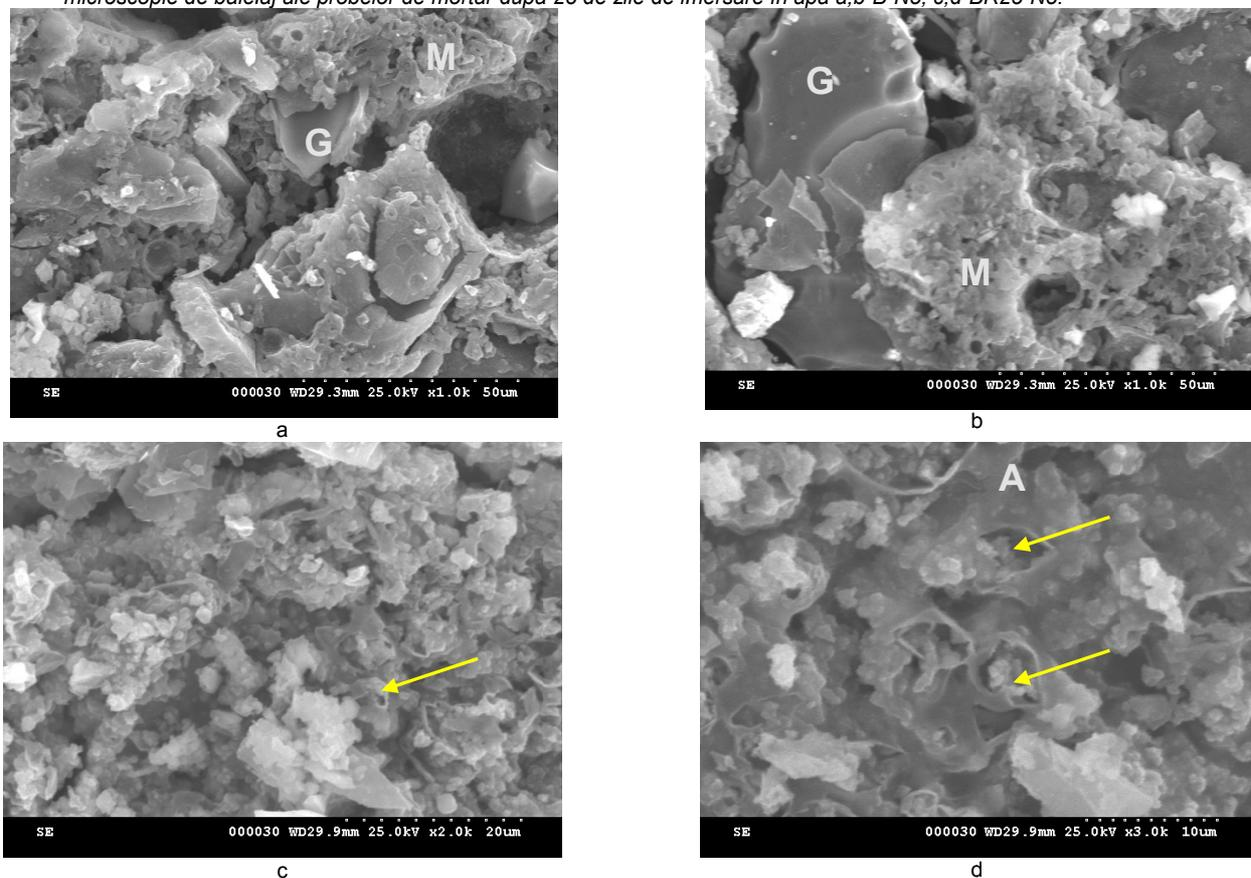
Fig. 12 - SEM micrographs of mortar specimens immersed 28 days in demineralized water a,b-G-N5, c,d- GR25-N5/ Imagini obținute prin microscopie de baleiaj ale probelor de mortar după 28 de zile de imersare în apă a,b-G-N5, c,d-GR25-N5.
