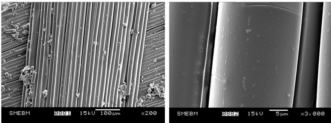
Fig. 4 - a) SEM analysis after GFRP pyrolysis / Analiza SEM după piroliza GFRP
