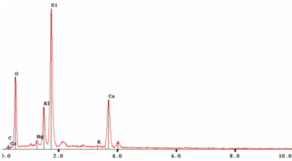
Fig. 5. - b) EDX analysis after GFRP pyrolysis followed by partial oxidation / Analiza EDX după piroliză urmată de oxidarea GFRP.
