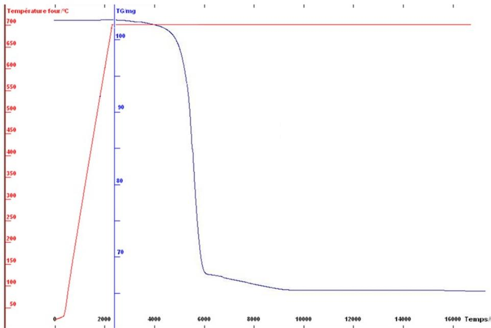
Fig. 7- Mass loss during CFRP pyrolysis followed by partial oxidation / Pierdere de masă în timpul pirolizei urmată de oxidarea parțială a CFRP.
