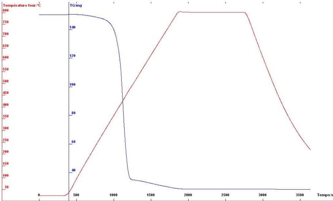
Fig. 3 - Mass loss during GFRP pyrolysis followed by partial oxidation / Pierderea de masă în timpul pirolizei urmată de oxidarea parțială a GFRP.
