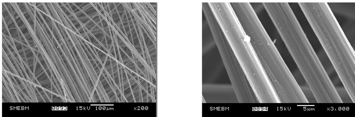
Fig. 9 - a) SEM analysis after CFRP pyrolysis followed by partial oxidation / Analiza SEM după piroliza urmată de oxidarea parțială a CFRP.
