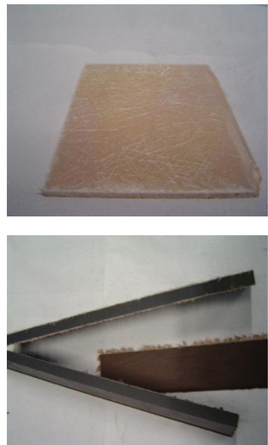
Fig 1 - Waste material used in experimental tests a) GFRP, b) CFRP / *Deșeuri utilizate în testele experimentale a) GFRP, b) CFRP.*
