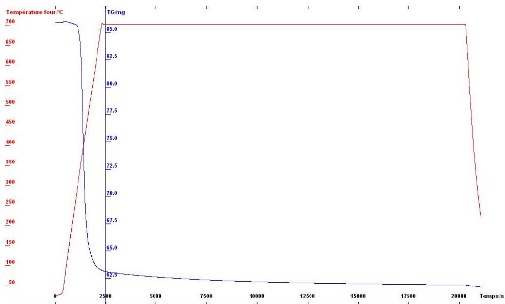
Fig. 6 - Mass loss during CFRP pyrolysis / Pierdere de masă în timpul pirolizei CFRP.
