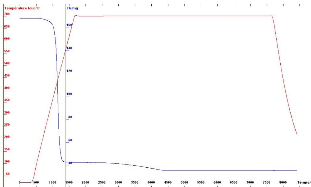
Fig. 2 - Mass loss during GFRP pyrolysis / Pierdereea de masă în timpul pirolizei GFRP.
