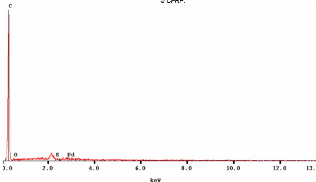
Fig. 9 - b) EDX analysis after CFRP pyrolysis followed by oxidation/ Analiza EDX după piroliza urmată de oxidarea parțială a CFRP.
