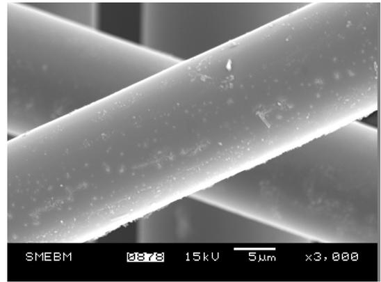
Fig. 5. - a) SEM analysis after GFRP pyrolysis followed by partial oxidation / Analiza SEM după piroliză urmată de oxidarea GFRP.
