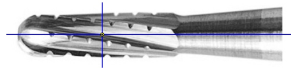
Fig. 1 - Sinowon VMM-1510P measuring – Tungsten carbide round end cross cut fissure dental bur / Măsurarea pe mașina Sinowon VMM-1510P a frezei cilindrice cu cap rotunjit din carbură de wolfram, pentru tăiat coroane dentare.
