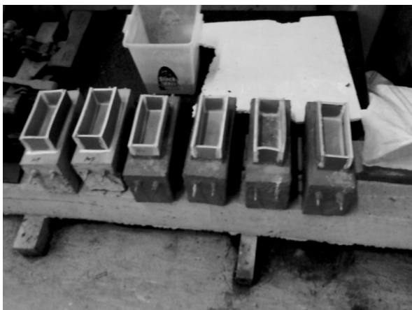
Fig. 1 – Prisme de beton cu armături înglobate / Concrete prisms with embedded reinforcing bars.
