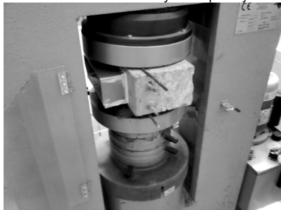
Fig. 3 – Spargerea prismelor pentru verificarea stării armăturilor / Breaking the prisms for visual inspection of the reinforced bars.
