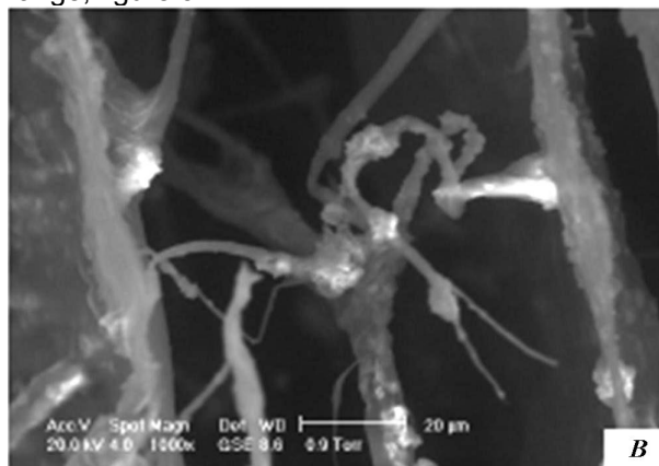
Fig.2 - Nanocompozite poroase (bureți) din TCP/Colagen, alcătuite dintr-o rețea de fibre de colagen pe suprafața cărora sunt depuse particule ceramice de \beta -TCP; A – pentru probele P1; B – pentru probele P2 / Porous samples (sponges) from TCP/Collagen nanocomposites showing the composite body consisting of collagen fibrous bundles with \beta -TCP deposits on the collagen surface; A – P1 sample; B – P2 sample.
