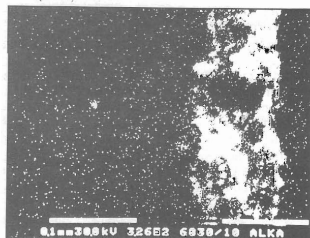
Fig.7- Distribuția în suprafață a intensității relative a radiației X caracteristice Al L_{\alpha 1} (x 326) Distribution through surface of relative intensity for characteristic X - ray radiation Al L_{\alpha 1} (x 326).
