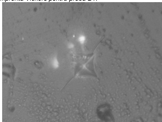
Fig. 4. b) Vickers imprint for sample B3/ Amprenta Vickers pentru proba B3.
