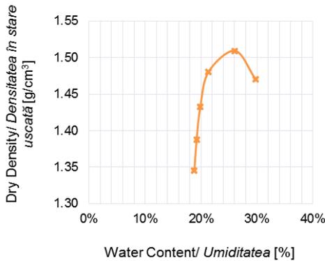
Fig. 6a - Compaction curve for brown clay/ *Curba de compactare pentru argila brună.*
