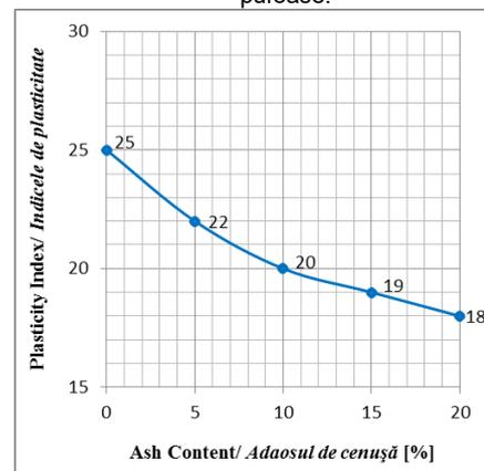
Fig. 5 - Variation of plasticity index at different added ash percentages/ Variația indicelui de plasticitate pentru diferite procente de adaos de cenușă.
