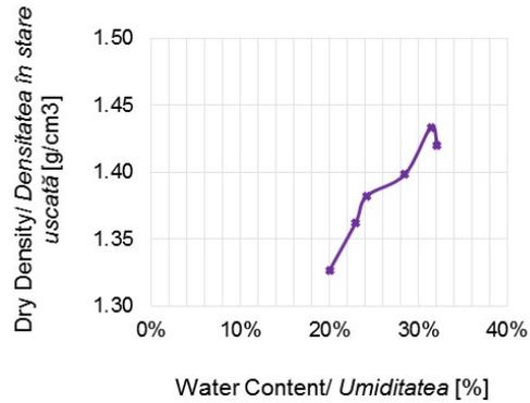
Fig. 6c - Compaction curve for brown clay with 10% oil shale ash/ *Curba de compactare pentru argila brună cu adaos de 10% cenușă provenită din șisturi bituminoase.*
