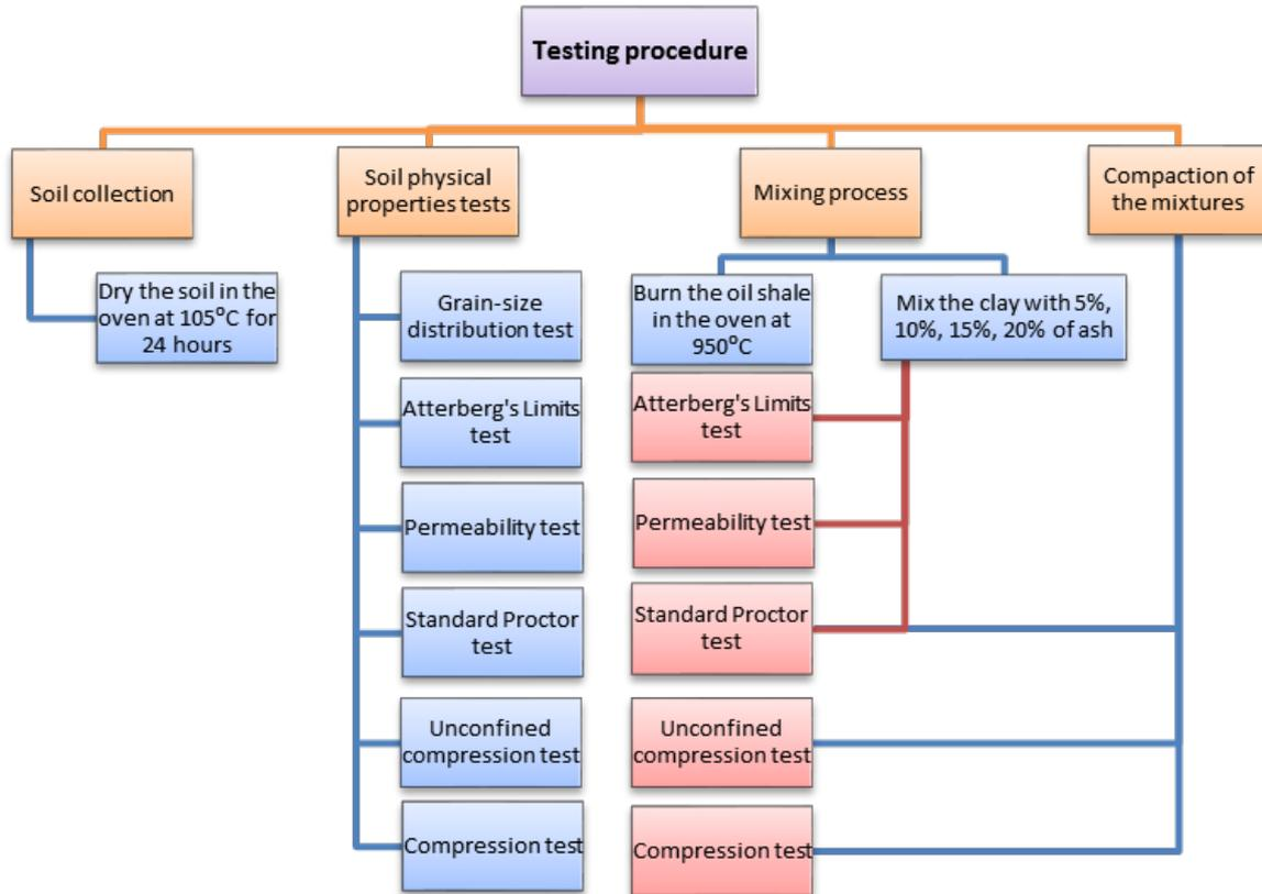
Fig.3 - Testing procedure/ Procedura de încercare.
