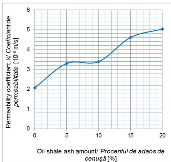
Fig. 7 - Permeability of brown clay mixed with different percentages of oil shale ash/ Permeabilitatea argilei brune amestecate cu diferite procente de cenușă provenită din șisturi bituminoase.
