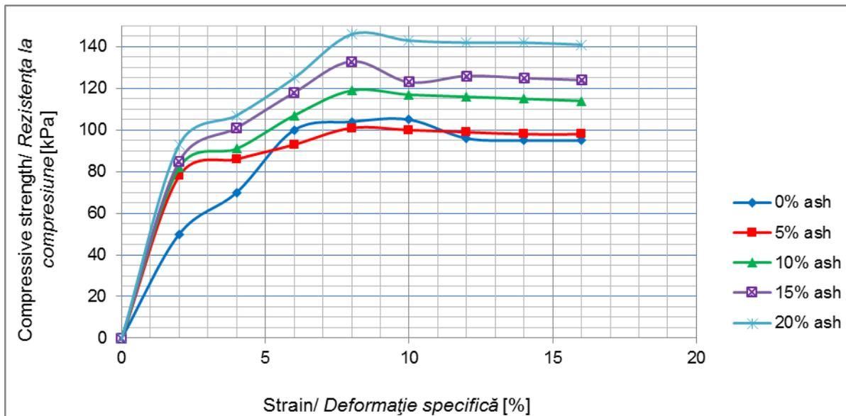
Fig. 9a - Unconfined compressive strength of the brown clay mixed with different percentages of oil shale ash at age of 7 days/ Rezistența la compresiune monoaxială a argilei brune amestecate cu diferite procente de cenușă provenită din șisturi bituminoase, determinată la 7 zile.
