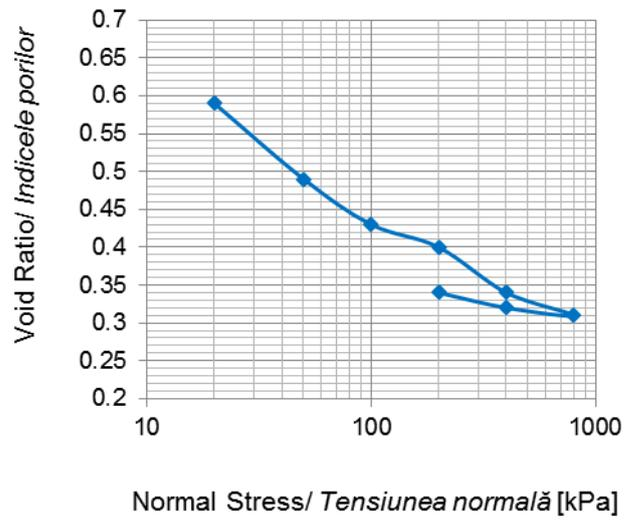
Fig. 10c - Consolidation curve of clay with 10% ash/ Curba de consolidare a argilei brune cu adaos de 10% cenușă provenită din șisturi bituminoase.
