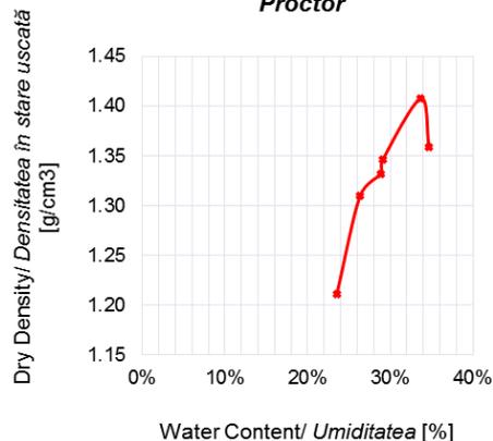
Fig. 6d - Compaction curve for brown clay with 15% oil shale ash/ *Curba de compactare pentru argila brună cu adaos de 15% cenușă provenită din șisturi bituminoase.*
