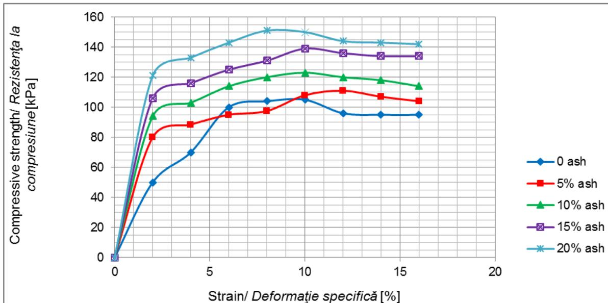
Fig. 9b - Unconfined compressive strength of the brown clay mixed with different percentages of oil shale ash at age of 21 days/ Rezistența la compresiune monoaxială a argilei brune amestecate cu diferite procente de cenușă provenită din șisturi bituminoase, determinată la 21 zile.
