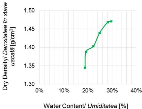
Fig. 6b - Compaction curve for brown clay with 5% oil shale ash/ *Curba de compactare pentru argila brună cu adaos de 5% cenușă provenită din șisturi bituminoase.*
