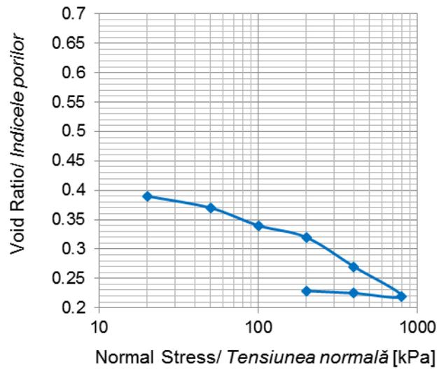
Fig. 10e - Consolidation curve of clay with 20% ash/ Curba de consolidare a argilei brune cu adaos de 20% cenușă provenită din șisturi bituminoase.
