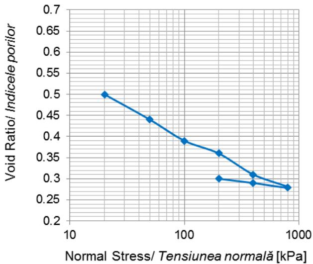
Fig. 10d - Consolidation curve of clay with 15% ash/ Curba de consolidare a argilei brune cu adaos de 15% cenușă provenită din șisturi bituminoase.
