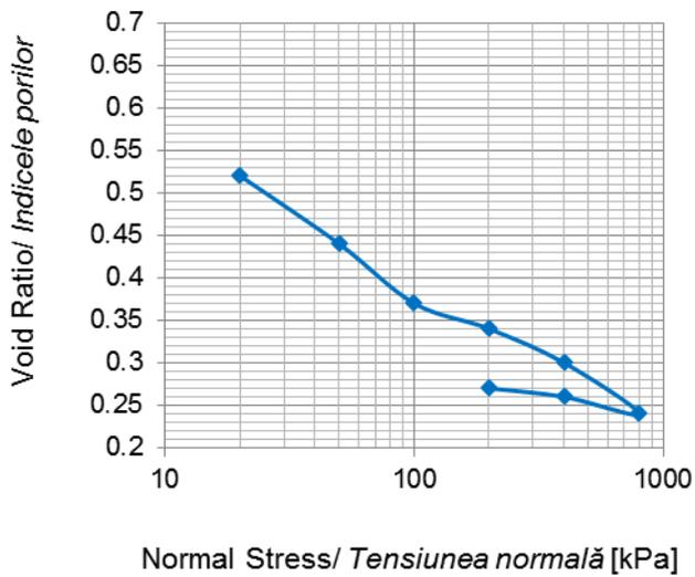
Fig. 10b - Consolidation curve of clay with 5% ash/ Curba de consolidare a argilei brune cu adaos de 5% cenușă provenită din șisturi bituminoase.
