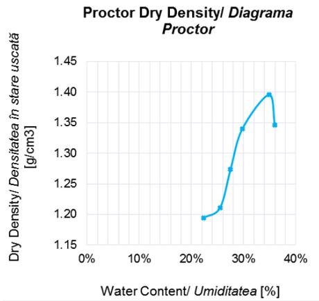
Fig. 6e - Compaction curve for brown clay with 20% oil shale ash/ Curba de compactare pentru argila brună cu adaos de 20% cenușă provenită din șisturi bituminoase.
