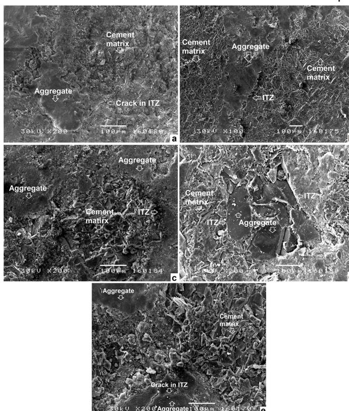
Fig. 9 - SEM images of SCCs: a) LF, b) RG c) FA, d) FT and e) RM.
