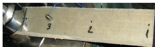
Fig. 5 - Platband with polystyrene core reinforced with steel wire mesh/ Platbandă cu miez din polistiren ranforsată cu plasă metalică.
