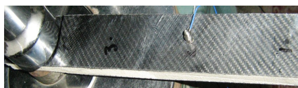
Fig. 3 - Platband with polystyrene core reinforced with carbon-fiber/ Platbandă cu miez din polistiren ranforsată cu fibră de carbon.
