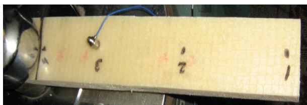
Fig. 1 - Platband with polystyrene core reinforced with fiber-glass/ Platbandă cu miez din polistiren ranforsată cu fibră de sticlă.
