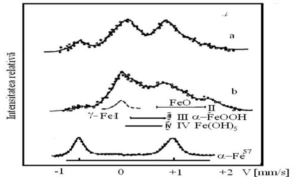
Fig. 8 -. Mössbauer spectra of Steel 3 samples processed by PEDM: / Spectrul Mössbauer pentru suprafețele pieselor executate din Oțel-3 și prelucrate cu PDEI:  $W=4.5$  J;  $S=2$  (a);  $S=0.5$  mm (b)
