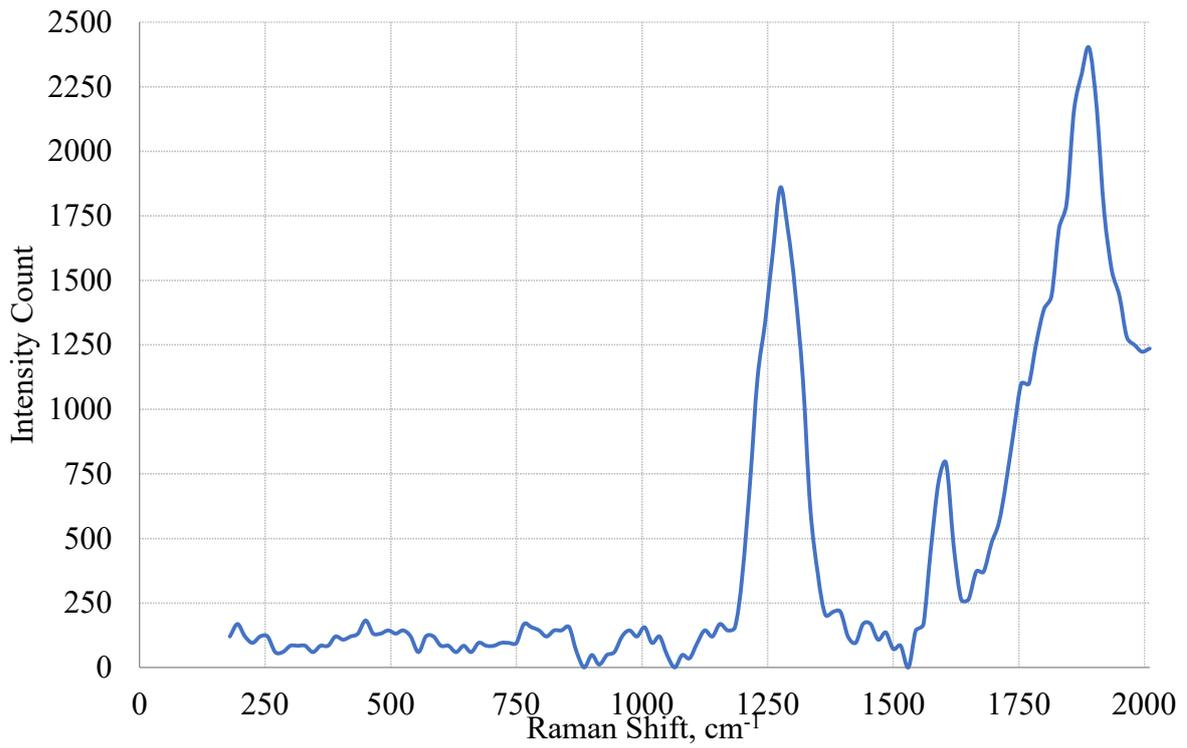
Fig. 6 - RAMAN spectrum of the carbon film (S=0,8mm,W=3,2 J, f=50Hz) .Spectrul RAMAN al filmului de carbon (S=0,8mm, W=3,2 J, f=50Hz)
