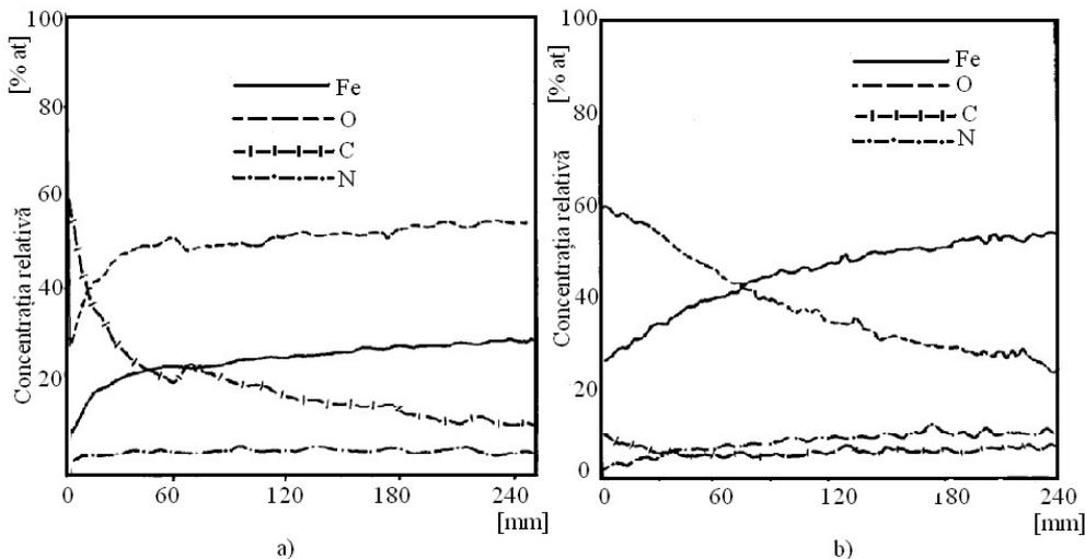
Fig. 9 - The concentration of elements in the processed layer depending on its depth for the sample made of Steel-3 for: / Dependenta concentrației elementelor în funcție de adâncimea stratului prelucrat pentru probe executate din Oțel-3 și prelucrare cu PDEI: (a),  $S=0.5$  mm  $W_s= 4,5J$  and (b);  $S=2$ mm and  $W_s= 4,5J$ ;
