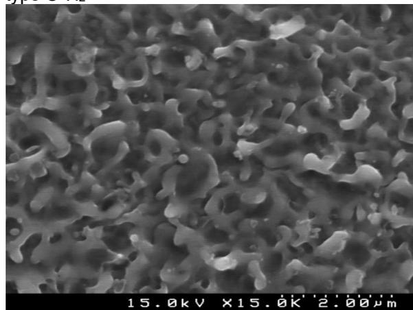
Fig. 10 - View obtained by electron microscopy of the morphology of the processed surface of the sample made of Steel-45 / Vedere a morfologie suprafeței piesei obținute prin metoda microscopiei electronice , piesa prelucrată fiind executată din Oțel-45
