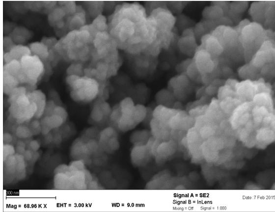
Fig.5 - Micro surface geometry of the tool-electrode (made of pyrolytic graphite) after interaction with pulsed electric discharge plasma / *Micro geometria suprafeței electrodului-piesă (executat din grafit pirolitic) după interacțiunea cu plasma descărcării electrice în impuls.*
