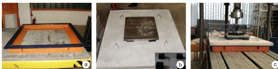
Fig. 4 - Organizarea experimentului: a) cadrul suport; b) dispozitivul de transmitere a încărcărilor; c) ansamblu experimental Experimental set-up: a) perimetral support system; b) load transmitting device; c) the experimental set-up.
