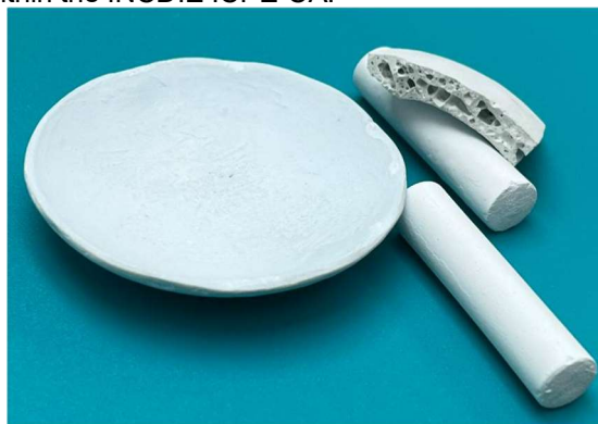
Fig. 2 - Experimental model of skull cap and wand obtained by casting in plaster molds in the INCDIE ICPE-CA laboratory / Calotă craniană și baghetă obținute prin turnare în forme de ipsos la INCDIE ICPE-CA
