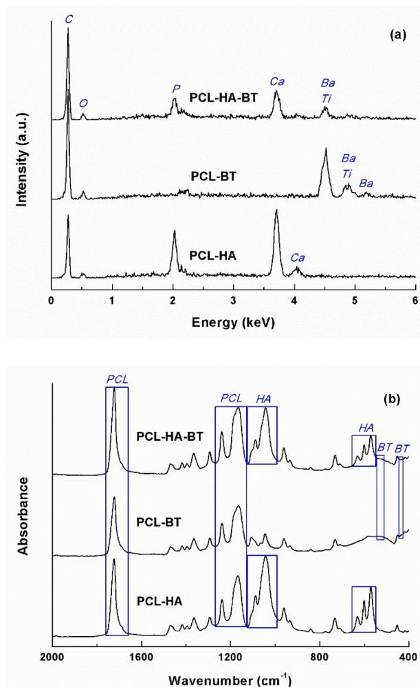
Fig. 4 - (a) EDX and (b) FTIR spectra of PCL-HA, PCL-BT and PCL-HA-BT scaffolds / Spectrele: (a) EDX și (b) FTIR ale scaffoldurilor PCL-HA, PCL-BT și PCL-HA-BT.
