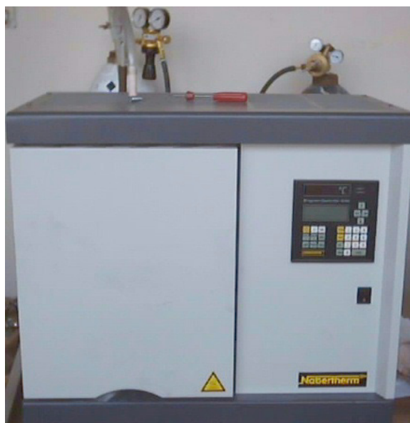
Fig. 3 - Ansamblu cuprinzând un cuptor electric cu bare de superkanthal și instalația de introdus azot în cuptor / Installation comprising an electric oven with superkanthal rods and apparatus to supply nitrogen in the oven.
