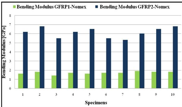
Fig. 6 - Bending modulus of the sandwich specimens/ Modulul de elasticitate la încovoiere a speciemenelor sandwich.
