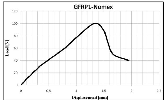
Fig. 3 - Load–displacement static bending behavior of the GFRP1-Nomex specimens/ *Comportamentul static la încovoiere și diagrama încărcare – deplasare pentru speciemenle GFRP1-Nomex.*
