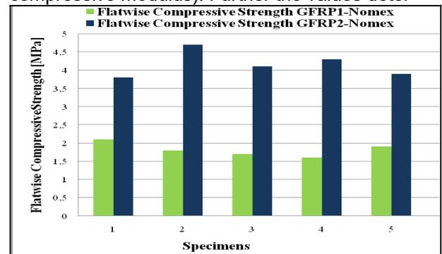
Fig. 7 - Flatwise compressive strength of the GFRP-Nomex specimens/ Rezistența la compresiune plană a speciemenelor GFRP-Nomex.
