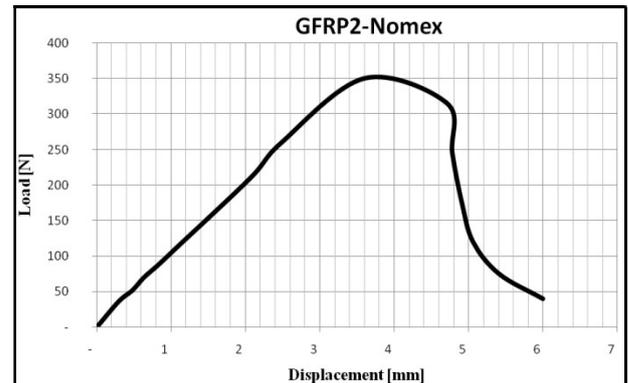
Fig. 4 - Load–displacement static bending behavior of the GFRP2-Nomex specimens/ *Comportamentul static la încovoiere și diagrama încărcare – deplasare pentru speciemenle GFRP2-Nomex.*
