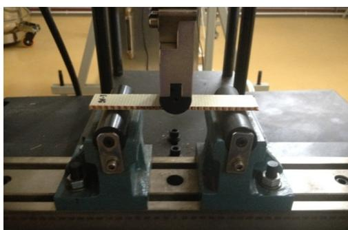
Fig. 1 - Three-point-bending test setup/ Schema de testare la încovoiere în trei puncte.
