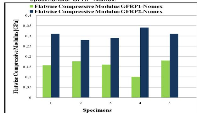
Fig. 8 - Flatwise compressive modulus of the GFRP-Nomex specimens/ Modulul de elasticitate la compresiune plană a speciemenelor GFRP-Nomex.
