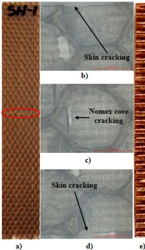
Fig. 10 – Failure mode of the GFRP1-Nomex specimen: a) top view; b), c), d) macroscopic views - 20X magnification; e) cross section view/ *Modurile de defectare ale speciemenelor GFRP1-Nomex: a) vedere de sus; b), c), d) imagini macroscopice cu mărire 20X; e) secțiune transversală a specimenului.*
