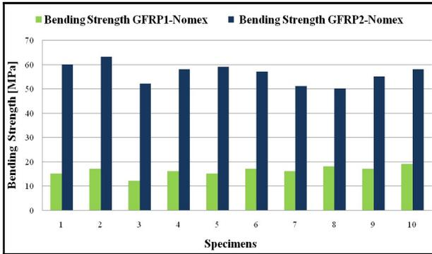
Fig. 5 - Bending strength of the sandwich specimens/ Rezistența la încovoiere a speciemenelor sandwich.
