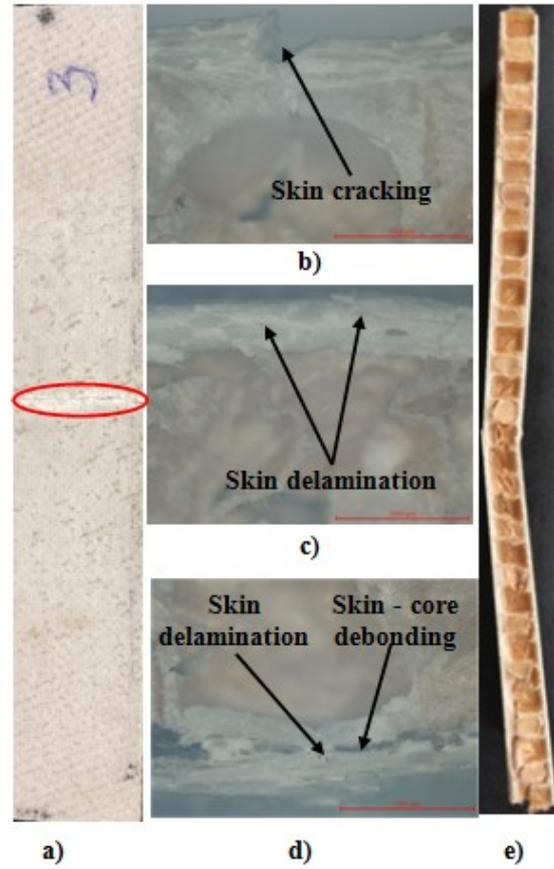
Fig. 11 – Failure mode of the GFRP2-Nomex specimen: a) top view; b), c), d) macroscopic views - 20X magnification; e) cross section view/ *Modurile de defectare ale speciemenelor GFRP2-Nomex: a) vedere de sus; b), c), d) imagini macroscopice cu mărire 20X; e) secțiune transversală a specimenului.*
