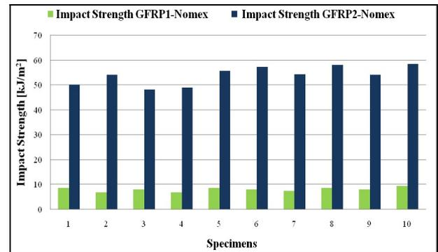
Fig. 9 - Charpy impact strengths of the GFRP-Nomex specimens/ *Rezistențele la impact Charpy ale speciemenelor GFRP-Nomex*.
