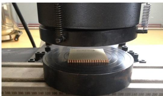
Fig. 2 - Flatwise compression test setup/ Schema de testare la compresiune plană.
